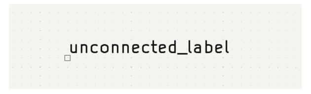
连接点相对于标签文本的位置可以通过在标签的属性中选择不同的标签方向,或通过镜像/旋转标签来改变。
