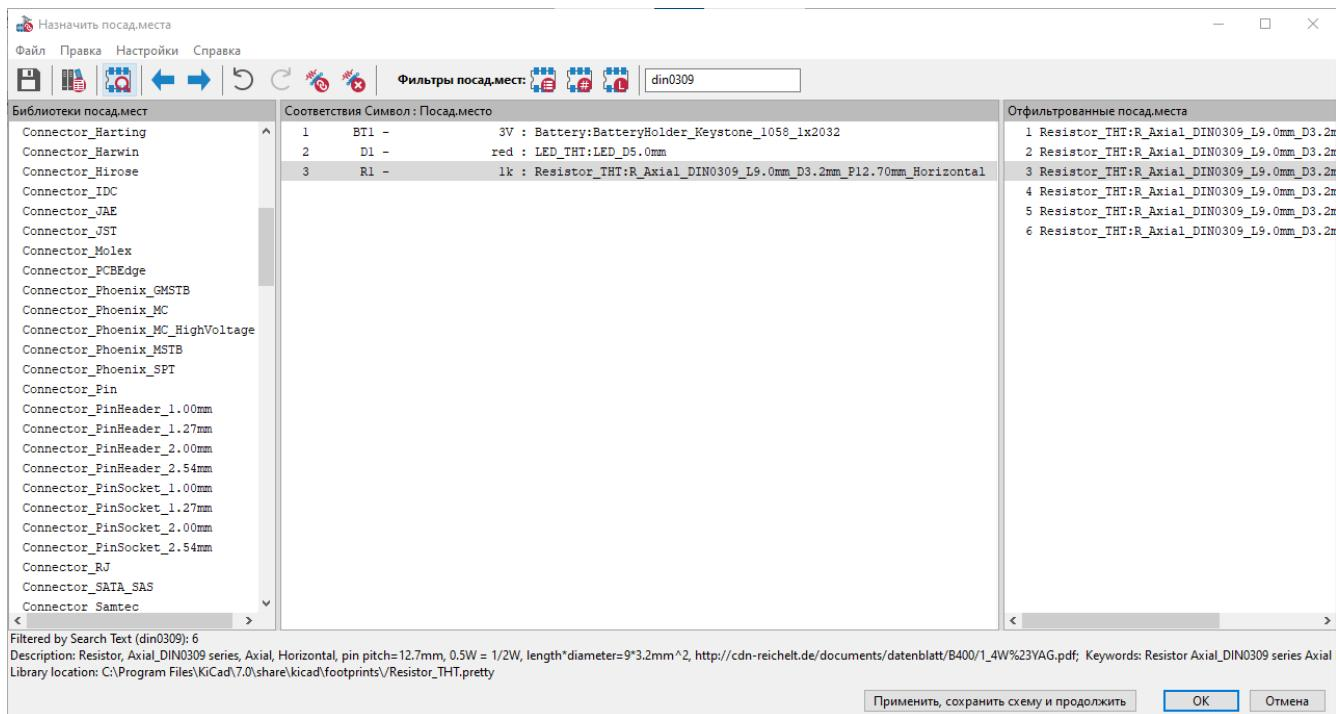
В состав KiCad входит множество посадочных мест, поэтому инструмент назначения посадочных мест предлагает несколько способов их фильтрации, позволяя скрыть те, которые не соответствуют рассматриваемому символу.
