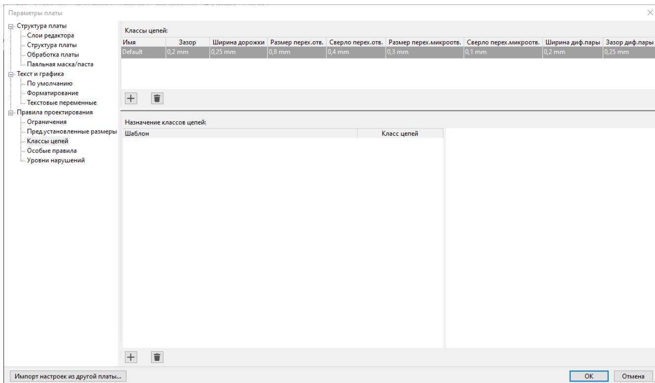
Ширина дорожек и расстояние между ними могут задаваться проектировщиком вручную - в процессе разводки, однако рекомендуется использовать классы цепей, поскольку они обеспечивают автоматический способ управления и проверку правил проектирования.
