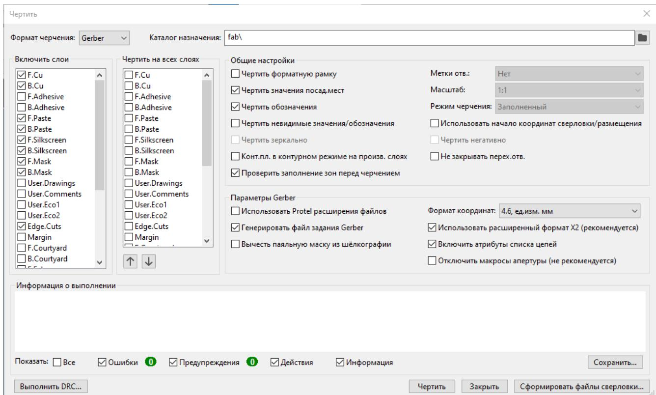
Нажмите кнопку **Чертить**, чтобы сгенерировать Gerber-файлы. Также нажмите кнопку **Сформировать файлы сверловки...** и в следующем окне нажмите на кнопку **Создать файл сверловки** для создания файлов, содержащих информацию о расположении всех отверстий, которые будут просверлены на плате. Наконец, закройте диалоговое окно "Чертить". Проектирование завершено.
