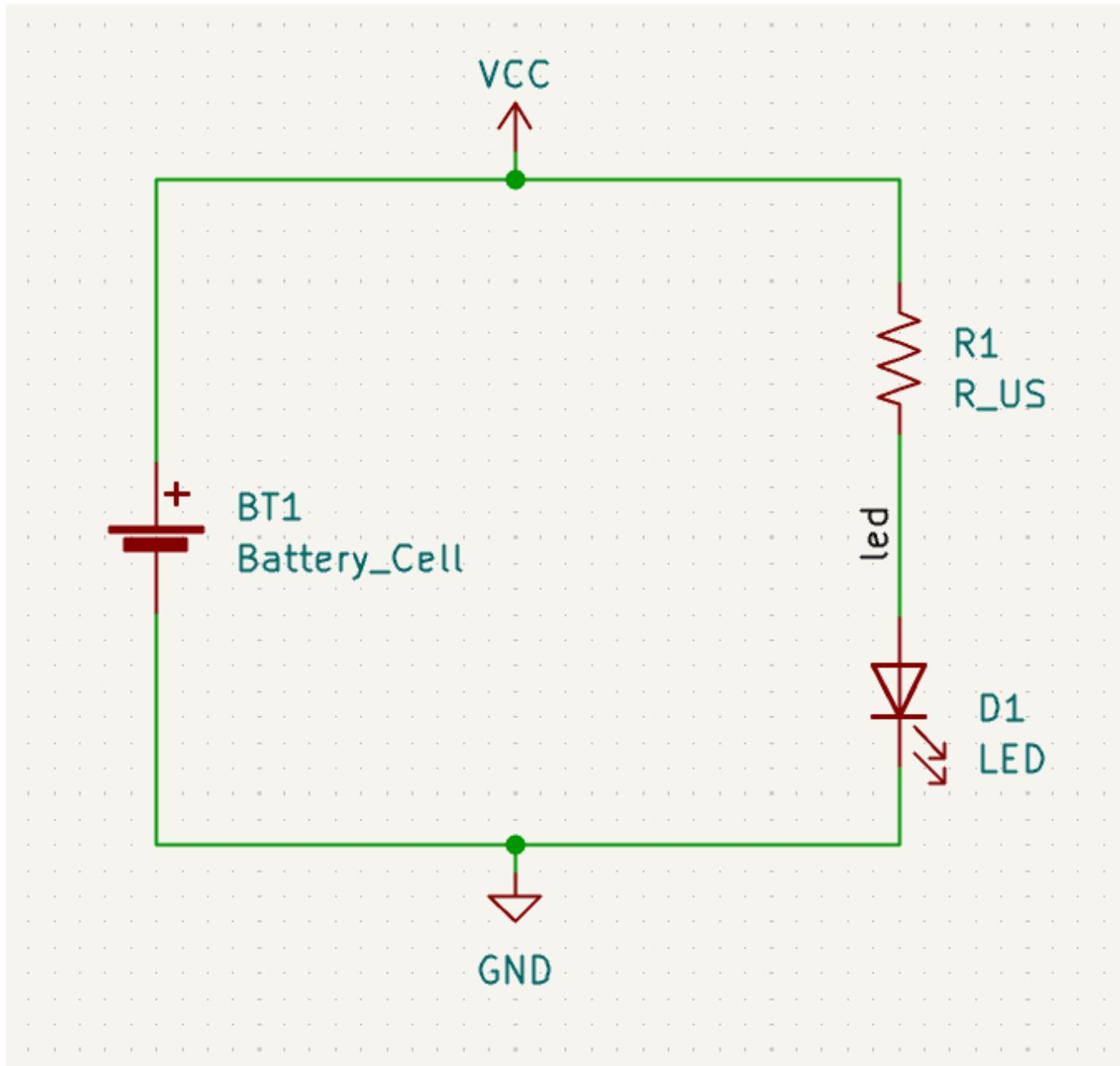
Обратите внимание на то, что метки с одинаковым именем объединяются в одну цепь. То же самое касается и символов питания с одинаковыми именами. Поэтому, если мы добавим на эту схему еще один символ GND или проводник с меткой led, то они буду соединены с уже существующими одноименными цепями даже без проводников, визуально их соединяющих.
