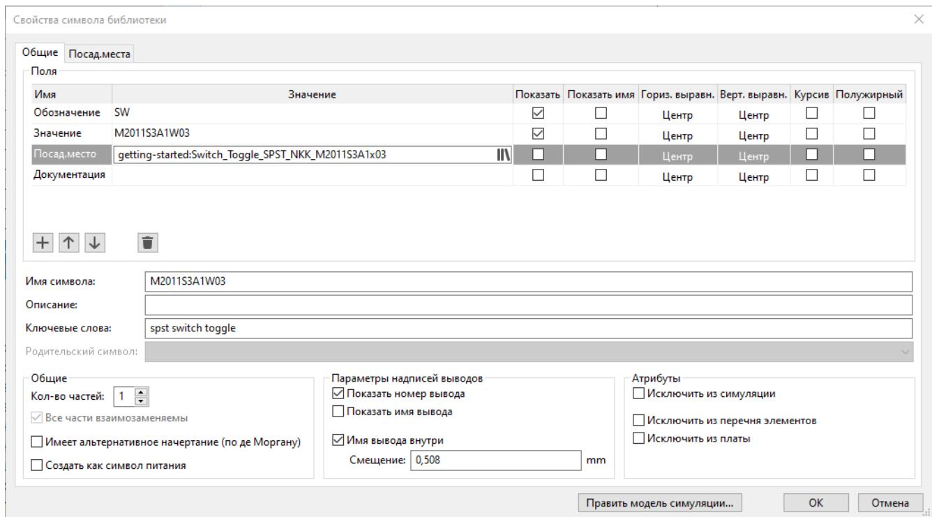
Откройте схему и добавьте новый символ, выбрав созданный нами ранее выключатель. Подключите его между светодиодом и плюсом батареи.
