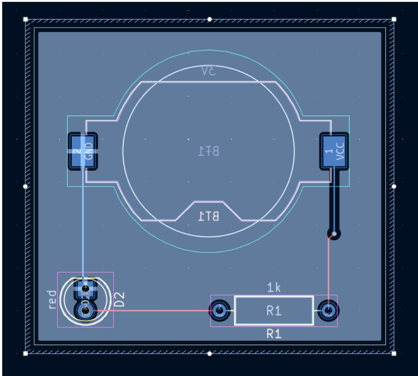
В KiCad зоны не заполняются автоматически при их создании, редактировании или при перемещении в них посадочных мест. Заполнение зон всегда производится вручную, а также при выполнении проверки правил проектирования (DRC) (примечание: если установлен соответствующий флажок). Убедитесь что заполнение зон актуально, прежде чем создавать [выходные данные для производства](#).
