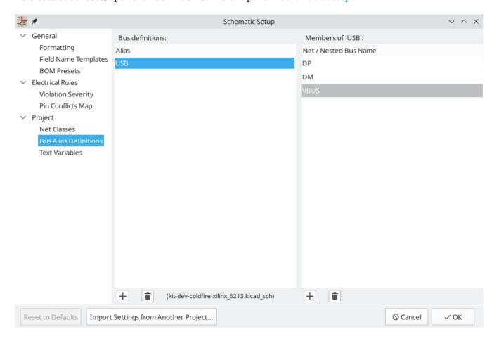
エイリアスには、有効な信号名なら何を付けても構いません。 ダイアログを使って、信号あるいはベクトル バスをエイリアスに追加することができます。 ショートカットとして、空白文字で区切られた信号やバスのリストに入力あるいは貼り付けでき、それらは全て、エイリアス定義に追加されます。 この例では、メンバー DP, DM, VBUS を持つ USB と呼ばれるエイリアスを定義します。
