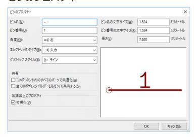
ピンプロパティダイアログでピンの全ての特性を編集することができます。このダイアログは、ピンを作成したり、あるいは既存のピンをダブルクリックすると、自動的にポップアップします。このメニューで以下の定義または変更が可能です。:
