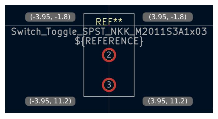
Wechseln Sie dann zur Lage F.Silkscreen. Die Siebdruckkontur sollte sich knapp außerhalb der Teilekontur befinden, daher werden die Siebdrucklinien 0,11 mm außerhalb der Linien auf der Fertigungsebene gezeichnet (0,11 mm ist die Hälfte der 0,10 mm breiten Fertigungslinien plus die Hälfte der 0,12 mm breiten Siebdrucklinien). Die genauen Koordinaten sind im Screenshot unten zu sehen, und hilfreiche Rastereinstellungen sind:
