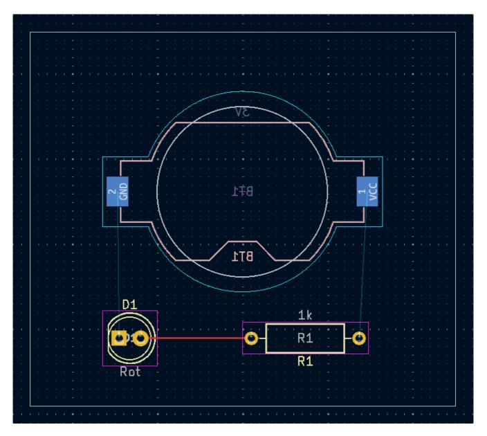
Zeichnen Sie nun eine Leiterbahn zwischen den GND-Pads von BT1 und D1, beginnend mit dem BT1-Pad auf der Rückseite der Platine. Beachten Sie, dass die aktive Ebene automatisch zu B.Cu wechselt, nachdem Sie auf das BT1-Pad geklickt haben. Klicken Sie auf das Pad D1, um die Leiterbahn zu vollenden.
