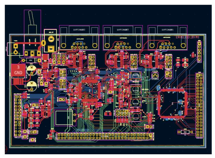
KiCad verfügt über separate Fenster zum Zeichnen des Schaltplans ("Schaltplaneditor"), zum Layouten der Leiterplatte ("Leiterplatteneditor") und zum Bearbeiten von Symbolen und Footprints ("Symboleditor" und "Footprinteditor"). KiCad wird mit einer großen Bibliothek von qualitativ hochwertigen, von Benutzern beigetragenen Symbolen und Footprints geliefert, aber es ist auch einfach, neue Symbole und Footprints zu erstellen oder bestehende Symbole und Footprints zu ändern.
