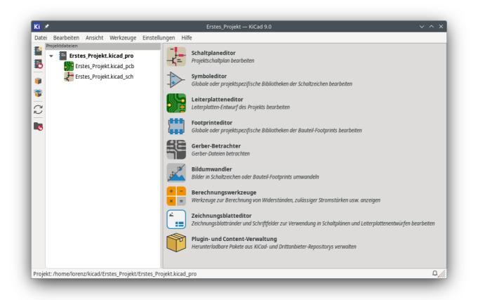
Auf der linken Seite sind im Bereich Projektdateien die Dateien des neuen Projekts aufgelistet. Es gibt eine Projektdatei mit der Erweiterung .kicad\_pro, eine Schaltplandatei mit der Erweiterung .kicad\_sch und eine Platinen-Datei mit der Erweiterung .kicad\_pcb. Diese Dateien haben alle den gleichen Namen wie Ihr Projekt.
