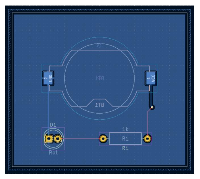
In KiCad werden Zonen nicht automatisch gefüllt, wenn sie zum ersten Mal gezeichnet oder geändert werden, oder wenn Footprints innerhalb der Zonen verschoben werden. Zonen werden durch manuelles Füllen gefüllt und wenn Sie den DRC ausführen. Stellen Sie sicher, dass die Zonenfüllungen auf dem neuesten Stand sind, bevor Sie Fertigungsdaten erzeugen.
