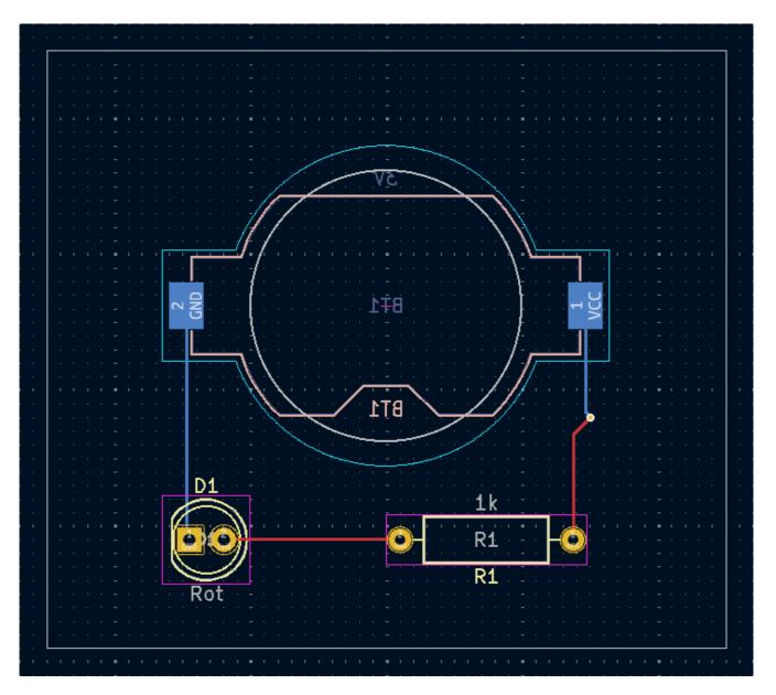
Zu diesem Zeitpunkt sind alle Verbindungen geroutet. Dies kann durch einen Blick auf den Statusbildschirm unten links im Fenster überprüft werden, wo die Anzahl der nicht gerouteten Netze mit 0 angegeben ist.
