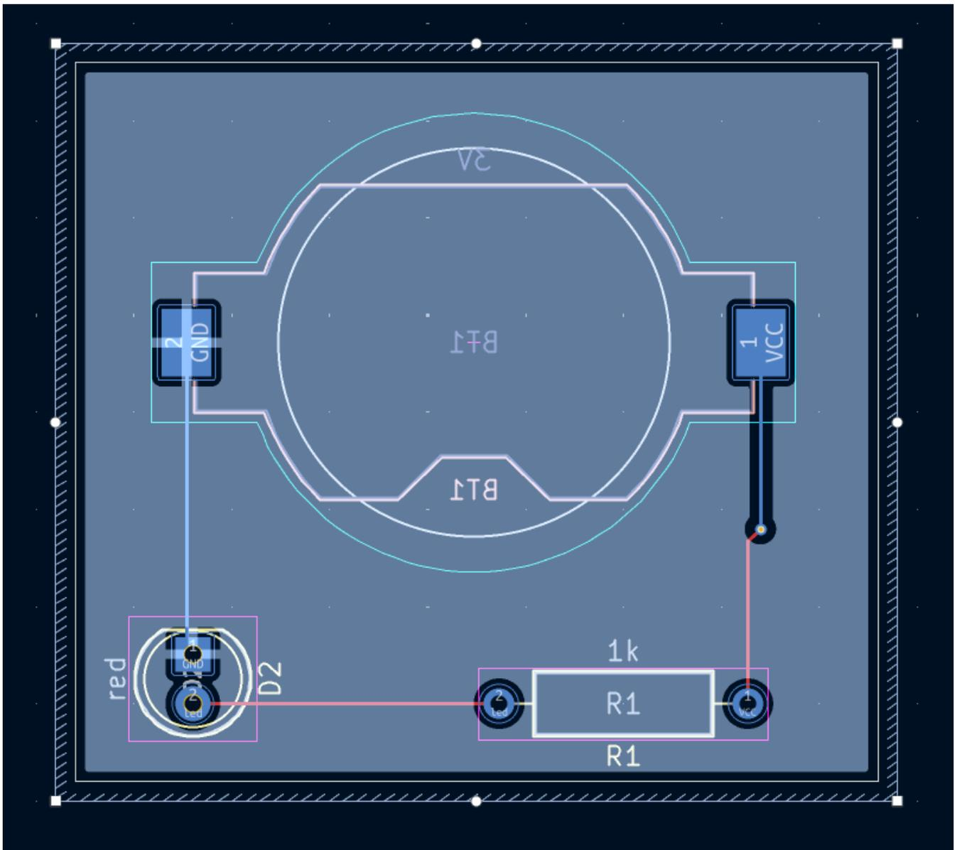
在 KiCad 中，当第一次绘制或修改敷铜时，或移动敷铜内的封装时，敷铜不会被自动填充。敷铜是通过手动填充和运行《DRC, DRC》时重新填充。在生成《制造, 制造输出》之前，请确保敷铜填充是最新的。
