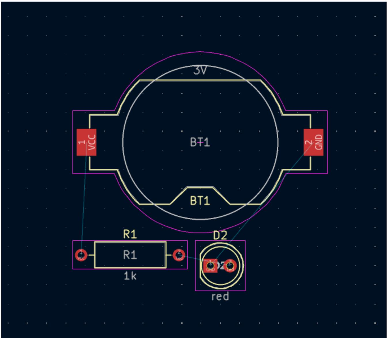
在 KiCad 中，根据原理图的变化更新 PCB 是一个手动过程：设计者决定何时适合根据原理图的修改来更新 PCB。每次编辑原理图时，设计者必须使用 **从原理图更新 PCB** 工具来保持原理图和布局的同步。
