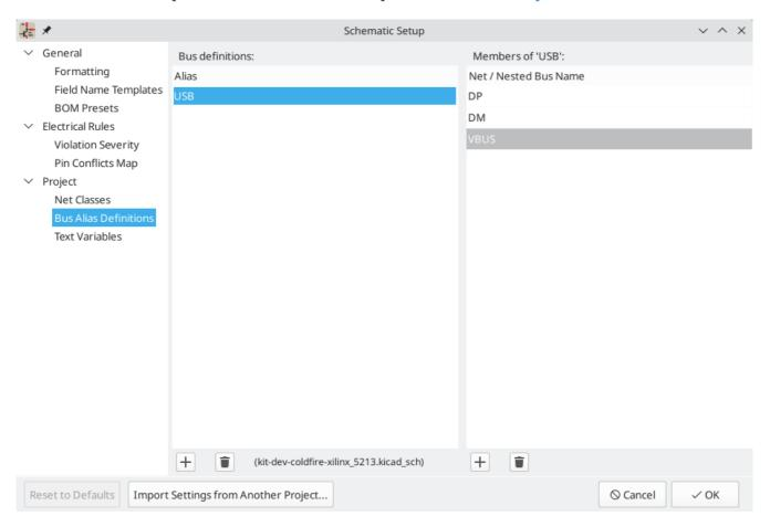
Имя псевдонима должно соответствовать требованиям именования меток. С помощью диалогового окна можно добавлять сигналы или векторные шины к псевдониму. Для экономии времени, можно вводить или вставлять сигналы и/или шины через пробел, они будут разделены и добавлены по отдельности. На показанном примере определён псевдоним с именем USB, содержащий сигналы DP, DM и VBUS.
