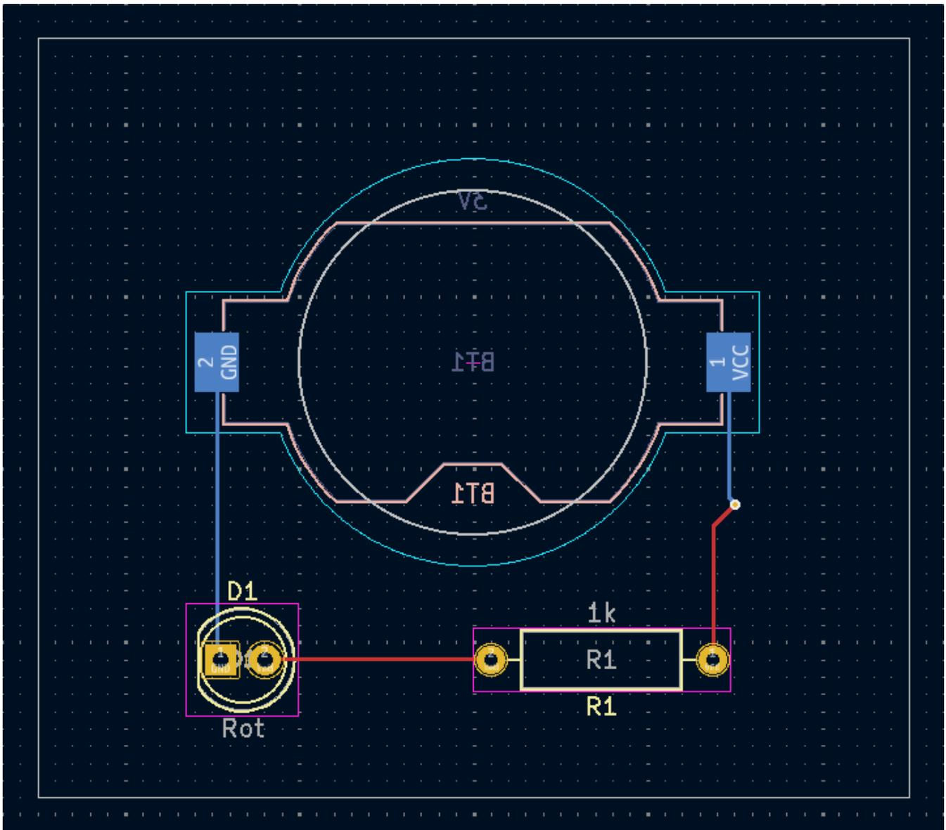
Zu diesem Zeitpunkt sind alle Verbindungen geroutet. Dies kann durch einen Blick auf den Statusbildschirm unten links im Fenster überprüft werden, wo die Anzahl der nicht gerouteten Netze mit 0 angegeben ist.
