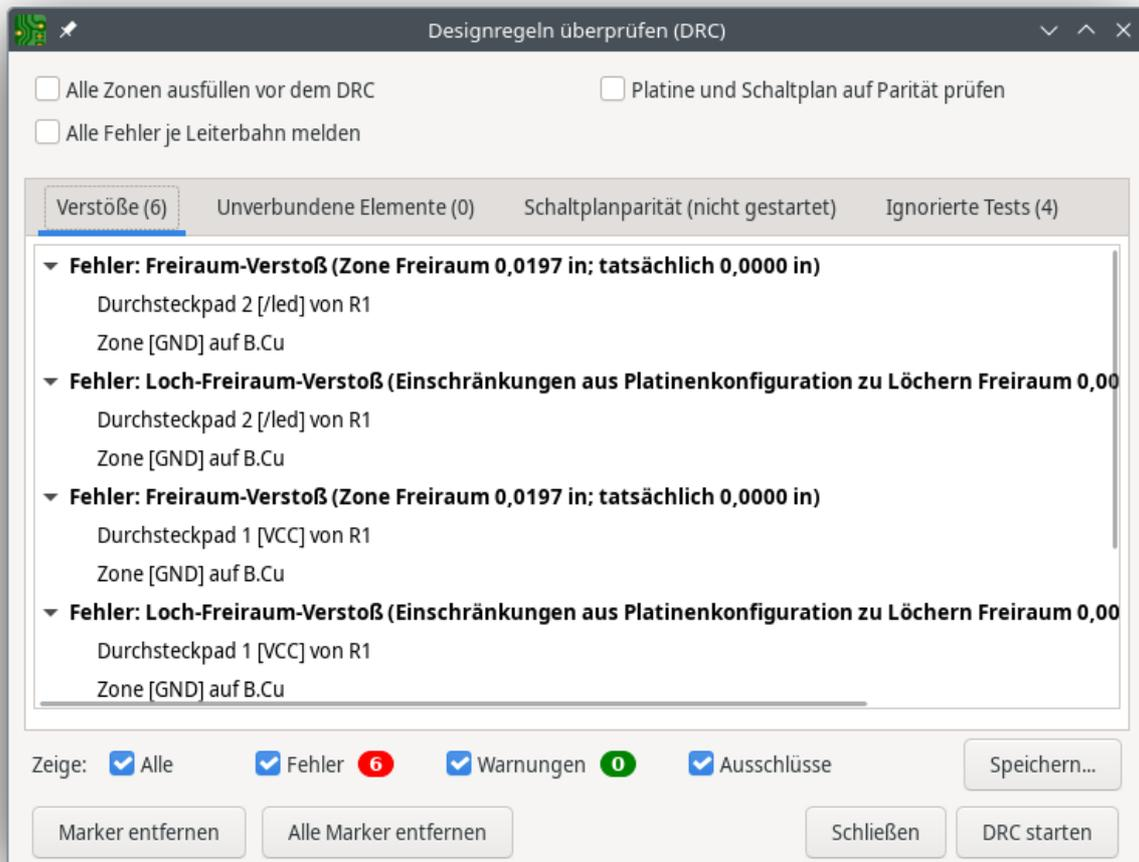
Schließen Sie den DRC-Dialog, drücken Sie **B**, um die Zone neu zu füllen, und führen Sie den DRC erneut aus. Alternativ können Sie auch das Kontrollkästchen **Alle Zonen ausfüllen vor dem DRC** aktivieren und den DRC erneut ausführen. Alle Verletzungen werden behoben.
