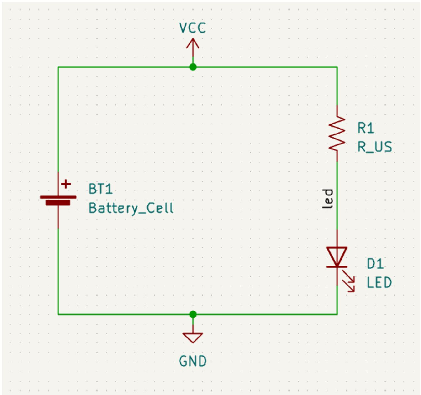
Beachten Sie, dass Beschriftungen und Spannungssymbole mit demselben Namen miteinander verbunden sind. Ein weiteres GND-Symbol oder eine Verbindung mit der Bezeichnung „led“ auf dieser Schaltplanseite würde mit dem vorhandenen kurzgeschlossen, auch wenn sie nicht optisch verbunden sind.
