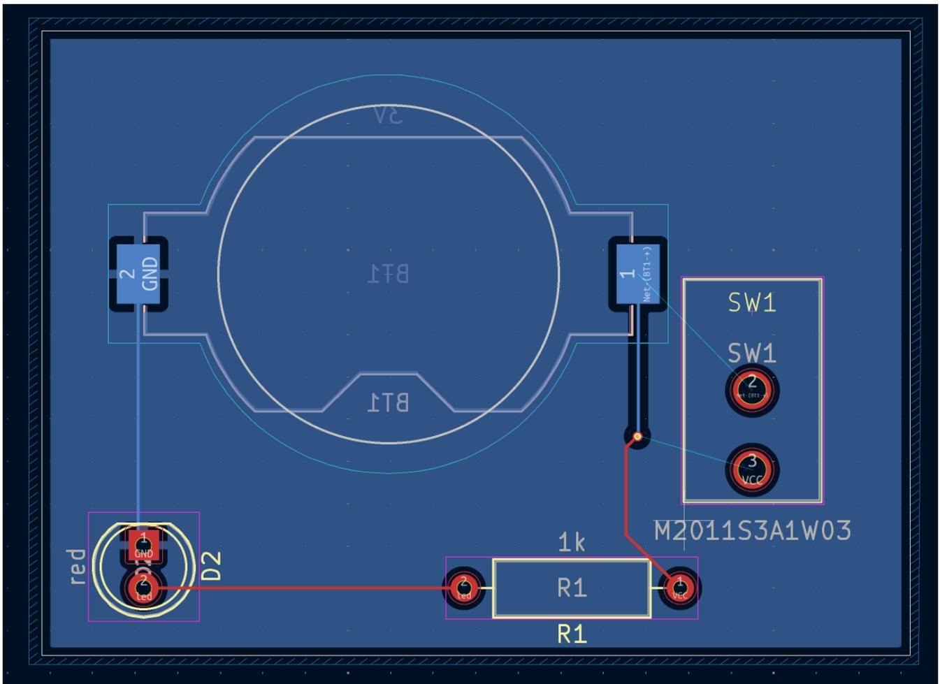
Das Rattennest zeigt die neuen Verbindungen, die verlegt werden müssen. Außerdem muss die Verbindung zwischen der Batterie und dem Widerstand entfernt werden.
