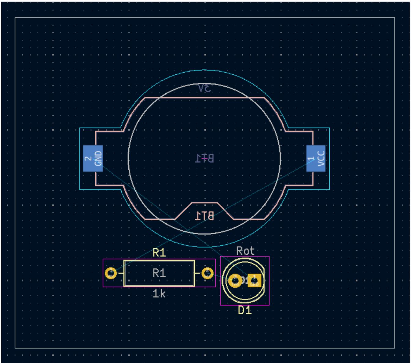
Alle Leiterplattenlagen werden von der Vorderseite der Leiterplatte aus betrachtet. Footprints auf der Unterseite der Leiterplatte stehen daher auf dem Kopf und erscheinen gespiegelt.
