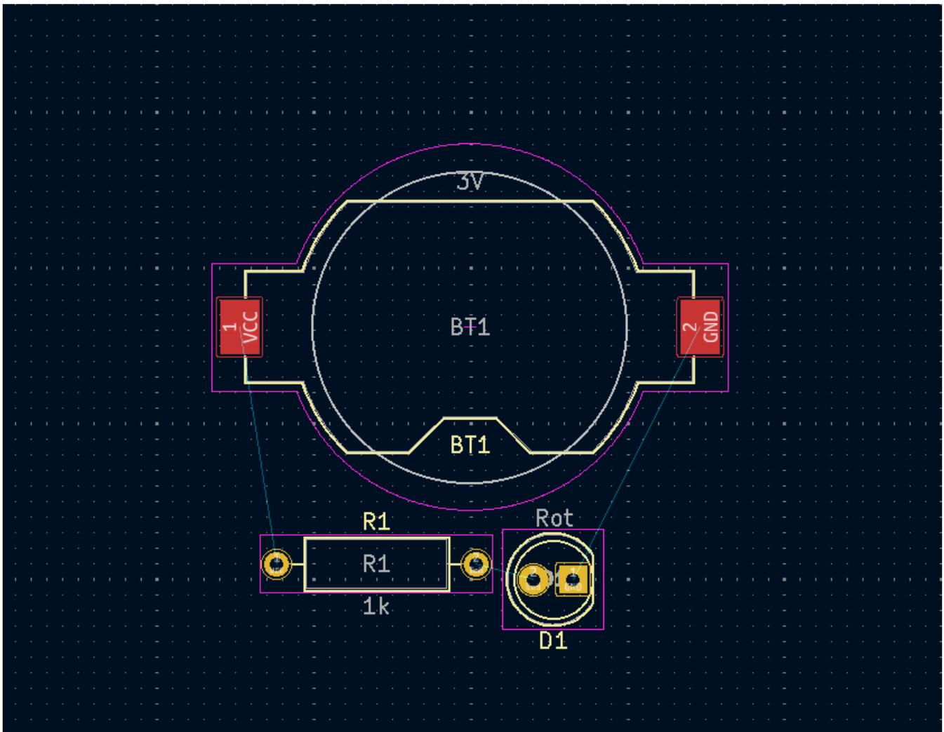
In KiCad ist das Aktualisieren der Leiterplatte mit Änderungen im Schaltplan ein manueller Prozess: Der Designer entscheidet, wann es angebracht ist, die Leiterplatte mit Änderungen im Schaltplan zu aktualisieren. Jedes Mal, wenn der Schaltplan bearbeitet wird, muss der Konstrukteur das Werkzeug **Platine aus Schaltplan aktualisieren** verwenden, um den Schaltplan und das Layout auf demselben Stand zu halten.
