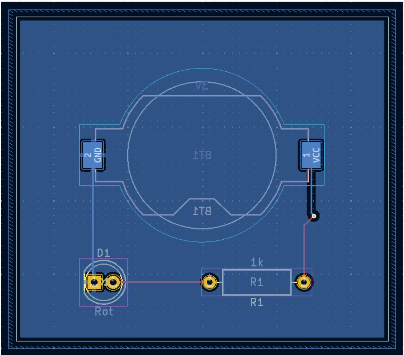
In KiCad werden Zonen nicht automatisch gefüllt, wenn sie zum ersten Mal gezeichnet oder geändert werden, oder wenn Footprints innerhalb der Zonen verschoben werden. Zonen werden durch manuelles Füllen gefüllt und wenn Sie den [DRC](#) ausführen. Stellen Sie sicher, dass die Zonenfüllungen auf dem neuesten Stand sind, bevor Sie [Fertigungsdaten](#) erzeugen.
