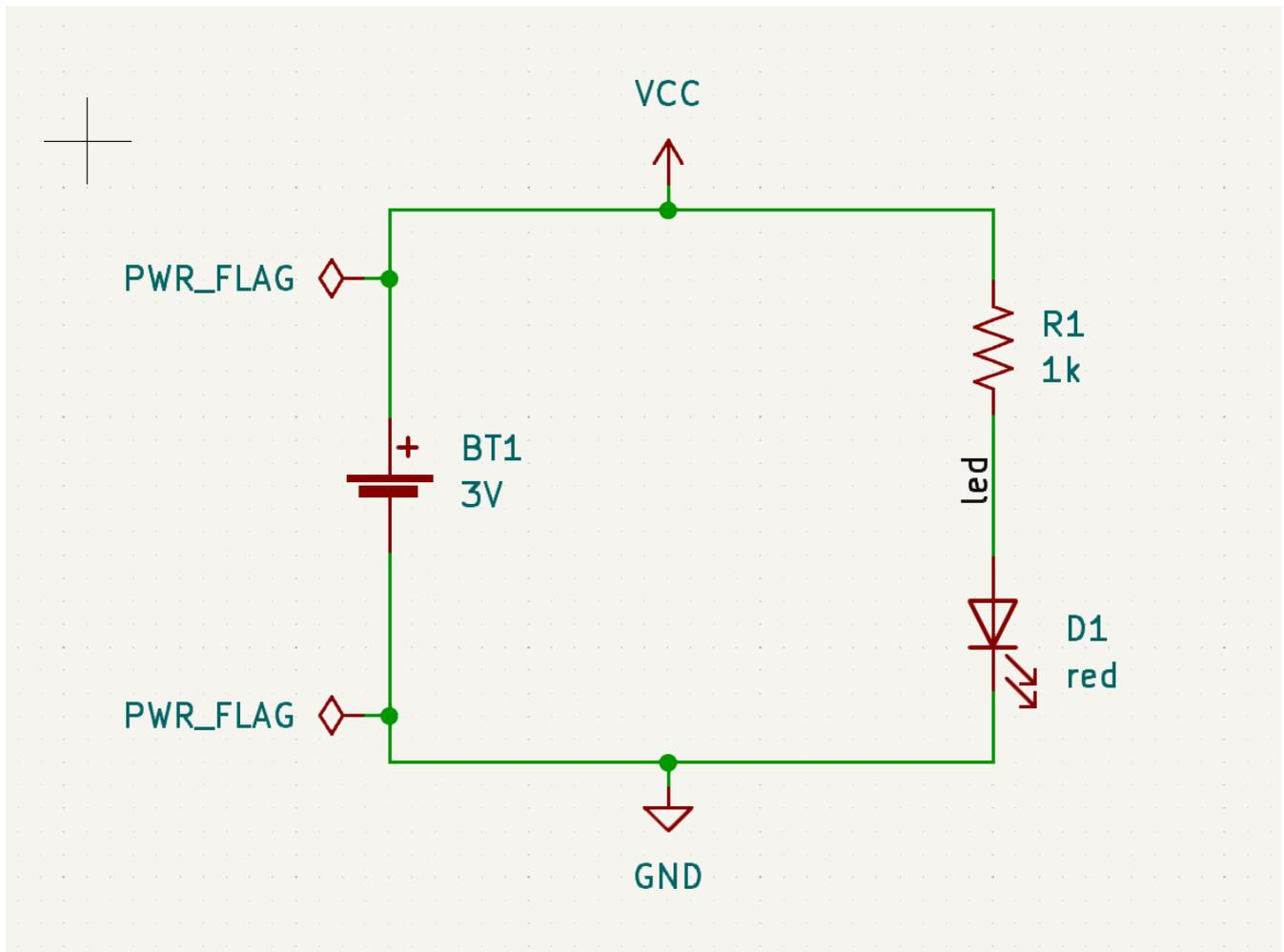
Es gibt ein spezielles PWR\_FLAG-Symbol in der Power-Symbolbibliothek, das dieses Problem löst, indem es KiCad mitteilt, dass die Netze tatsächlich angesteuert werden. Fügen Sie dieses Symbol zu den VCC- und GND-Netzen hinzu und führen Sie ERC erneut aus. Wenn ERC ohne Verstöße durchläuft, ist der Schaltplan vollständig.
