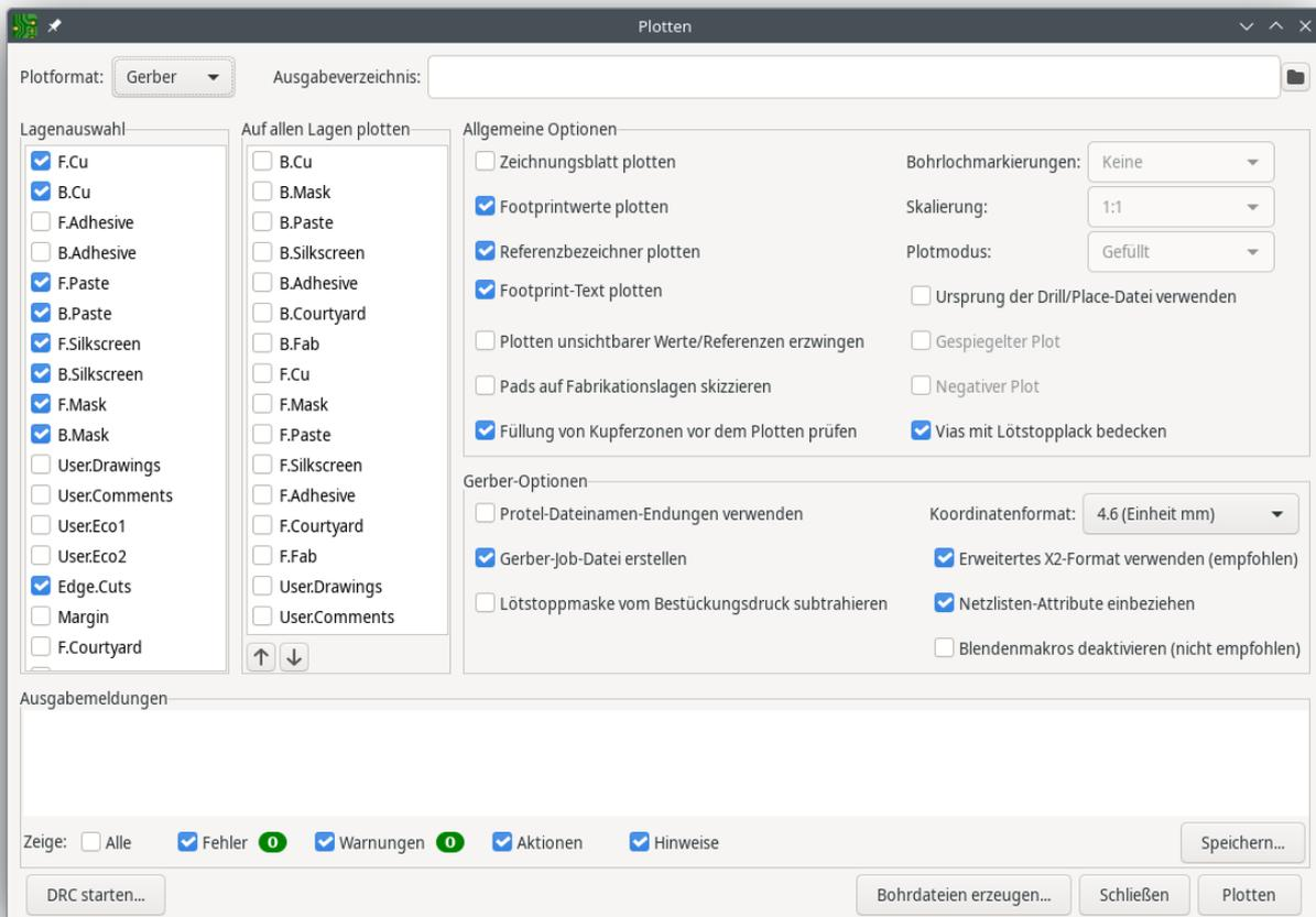
Klicken Sie auf **Plotten**, um die Gerberdateien zu erzeugen. Klicken Sie auch auf **Bohrdateien erzeugen...** und dann auf **Bohrdatei generieren**, um Dateien zu erstellen, die die Position aller Löcher angeben, die in die Platine gebohrt werden sollen. Schließen Sie abschließend den Plot-Dialog. Der Entwurf ist damit abgeschlossen.
