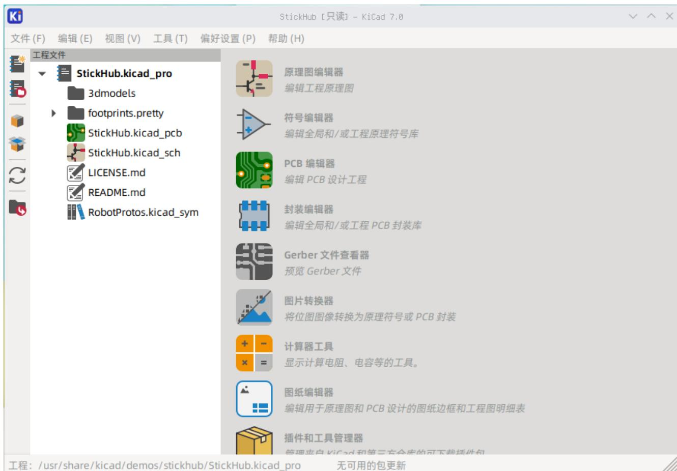
KiCad 工程管理器窗口由左侧的工作区视图和右侧的启动器组成，前者显示与打开的工程相关的文件，后者则包含各种编辑器和工具的快捷方式。
