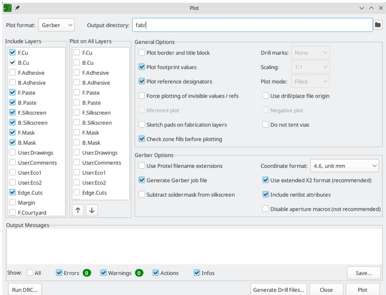
点击 **绘制** 来生成 Gerber 文件。同时点击 **生成钻孔文件...**，然后点击 **生成钻孔文件** 来创建文件，指定所有将在电路板上钻孔的位置。最后，关闭 "绘制" 对话框。设计就完成了。
