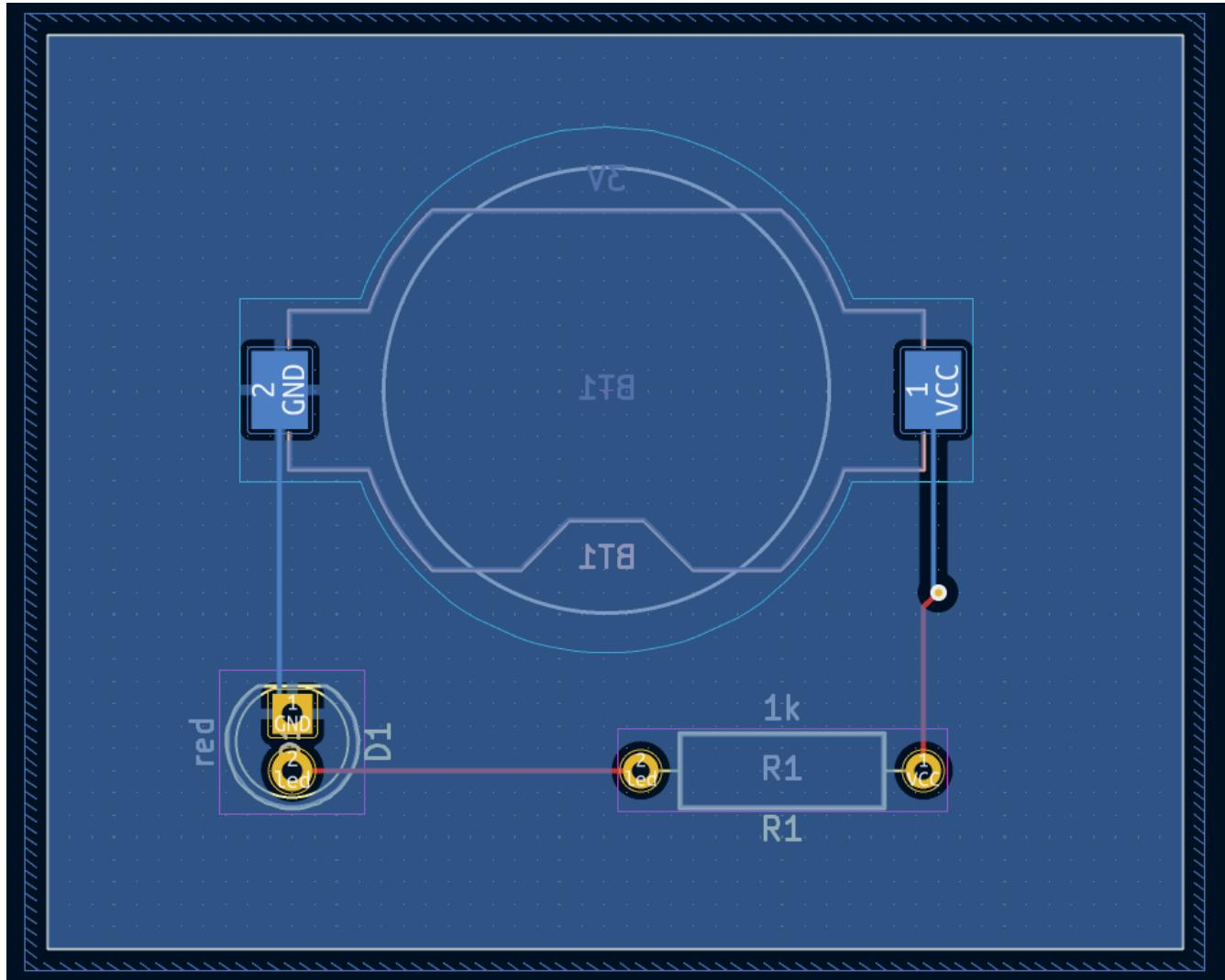
在 KiCad 中，当第一次绘制或修改敷铜时，或移动敷铜内的封装时，敷铜不会被自动填充。敷铜是通过手动填充和运行《DRC, DRC》时重新填充。在生成《制造, 制造输出》之前，请确保敷铜填充是最新的。
