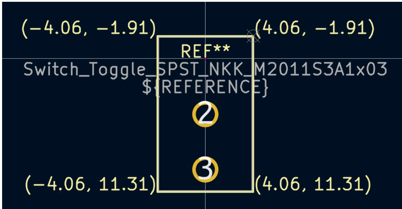
最后，选择 F.Courtyard 层。边框的边框应该以 0.25 mm 的间隙围绕着这个元件。
