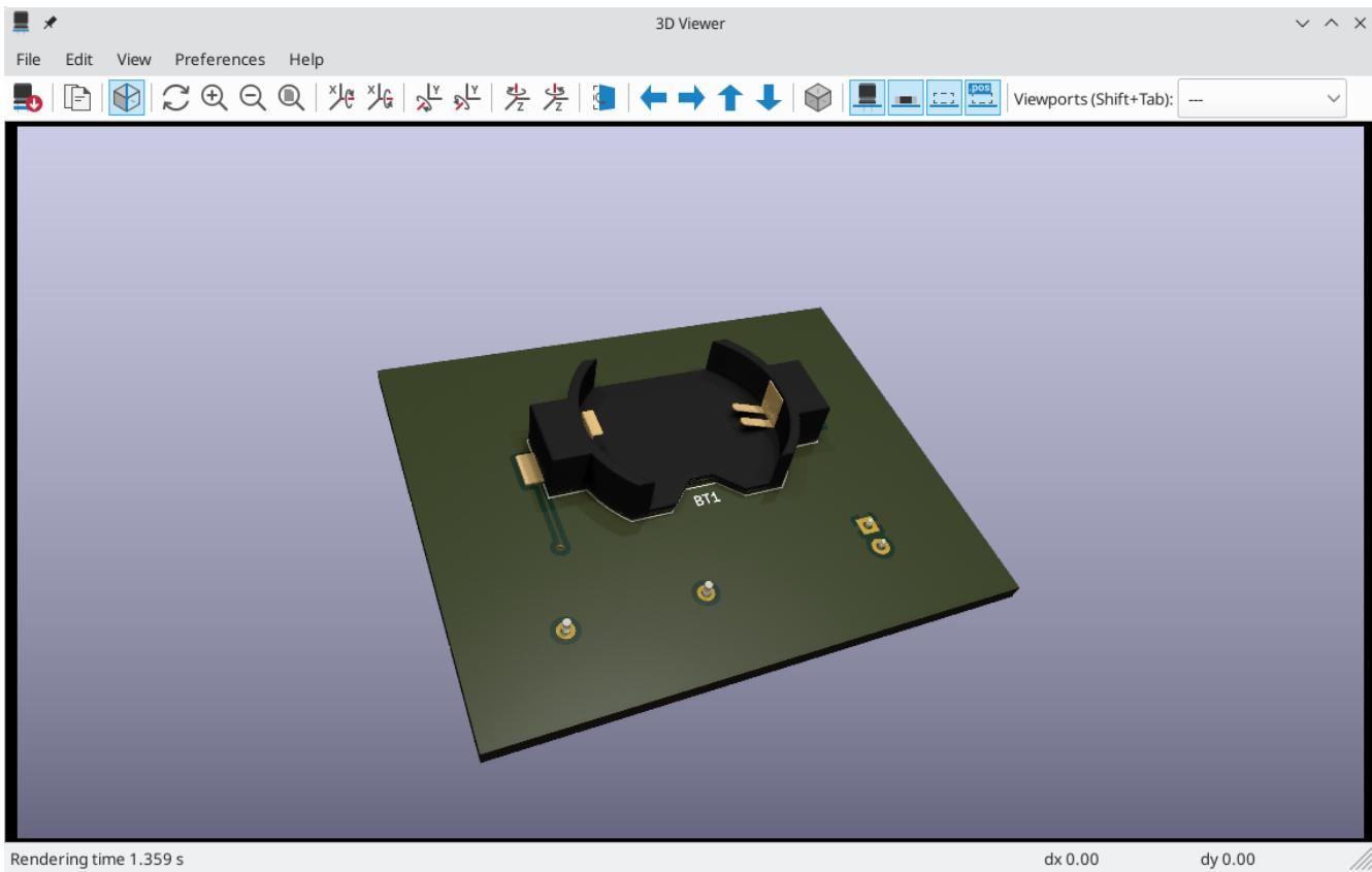
KiCad 库中的许多封装都带有 3D 模型，包括本指南中使用的所有封装。有些封装没有附带 3D 模型，《封装和 3D 模型》，但用户可以添加自己的模型》。
