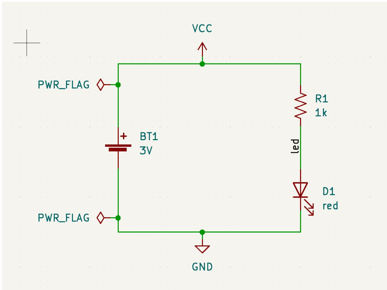
在 Power 符号库中有一个特殊的 PWR\_FLAG 符号，用于解决这个问题，告诉 KiCad 这些网络实际上是被驱动的。将这个符号添加到 VCC 和 GND 网络上，然后重新运行 ERC。当 ERC 通过而没有任何违反时，原理图就完成了。
