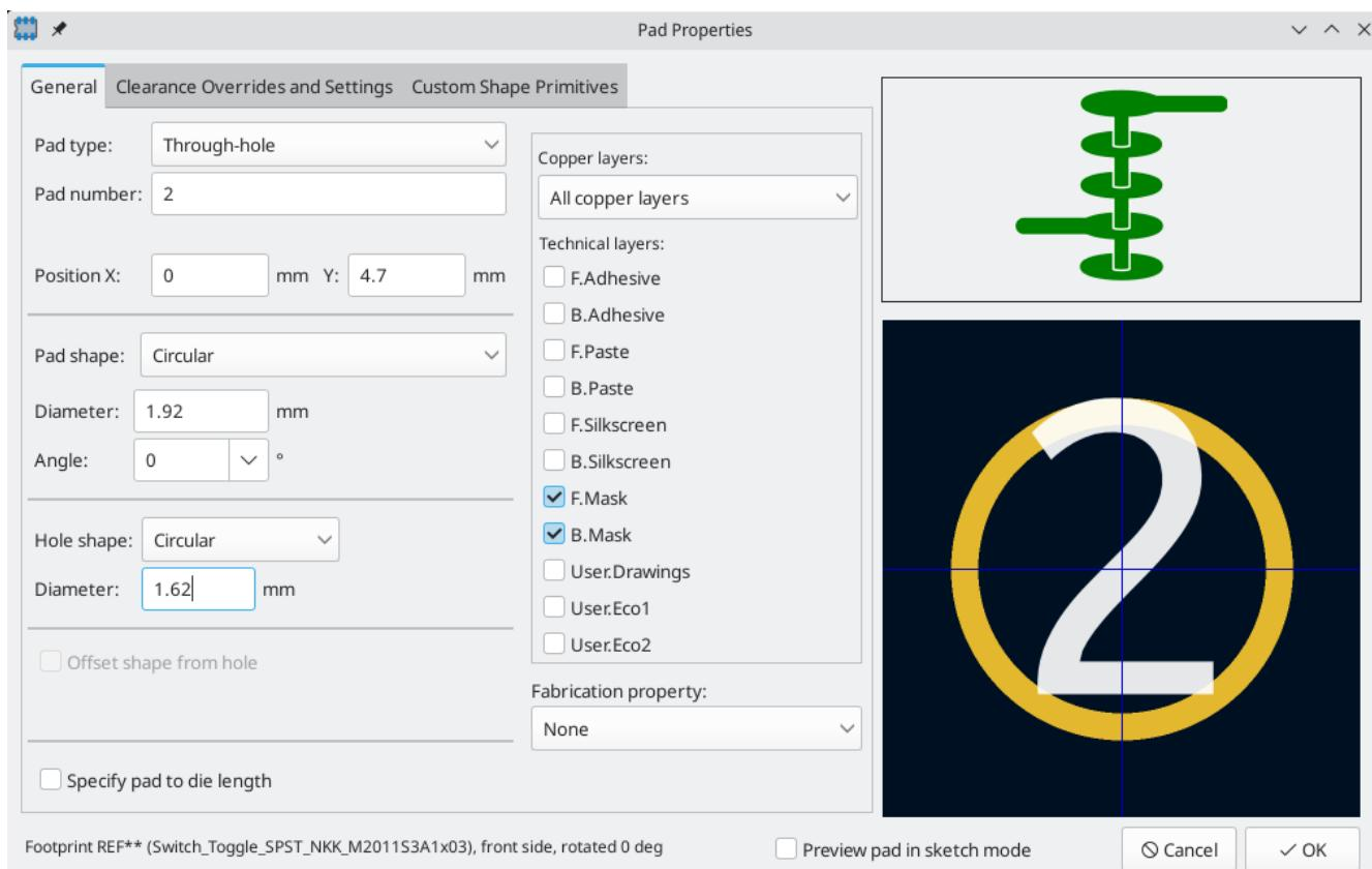
现在再次使用 **添加焊盘** 工具，将另一个焊盘放在 (0, 9.4mm) 处。注意，焊盘的编号会自动递增，包括焊盘尺寸和通孔的大小在内的属性会从前一个焊盘上复制下来。
