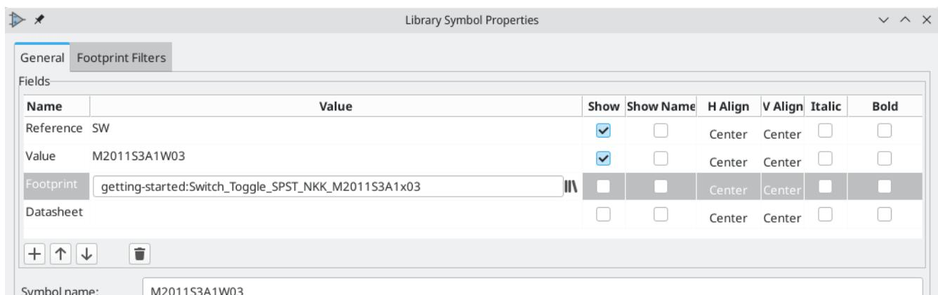
打开原理图，添加一个新符号，并选择新的开关符号。给它接线以连接或断开 LED 和电池。
