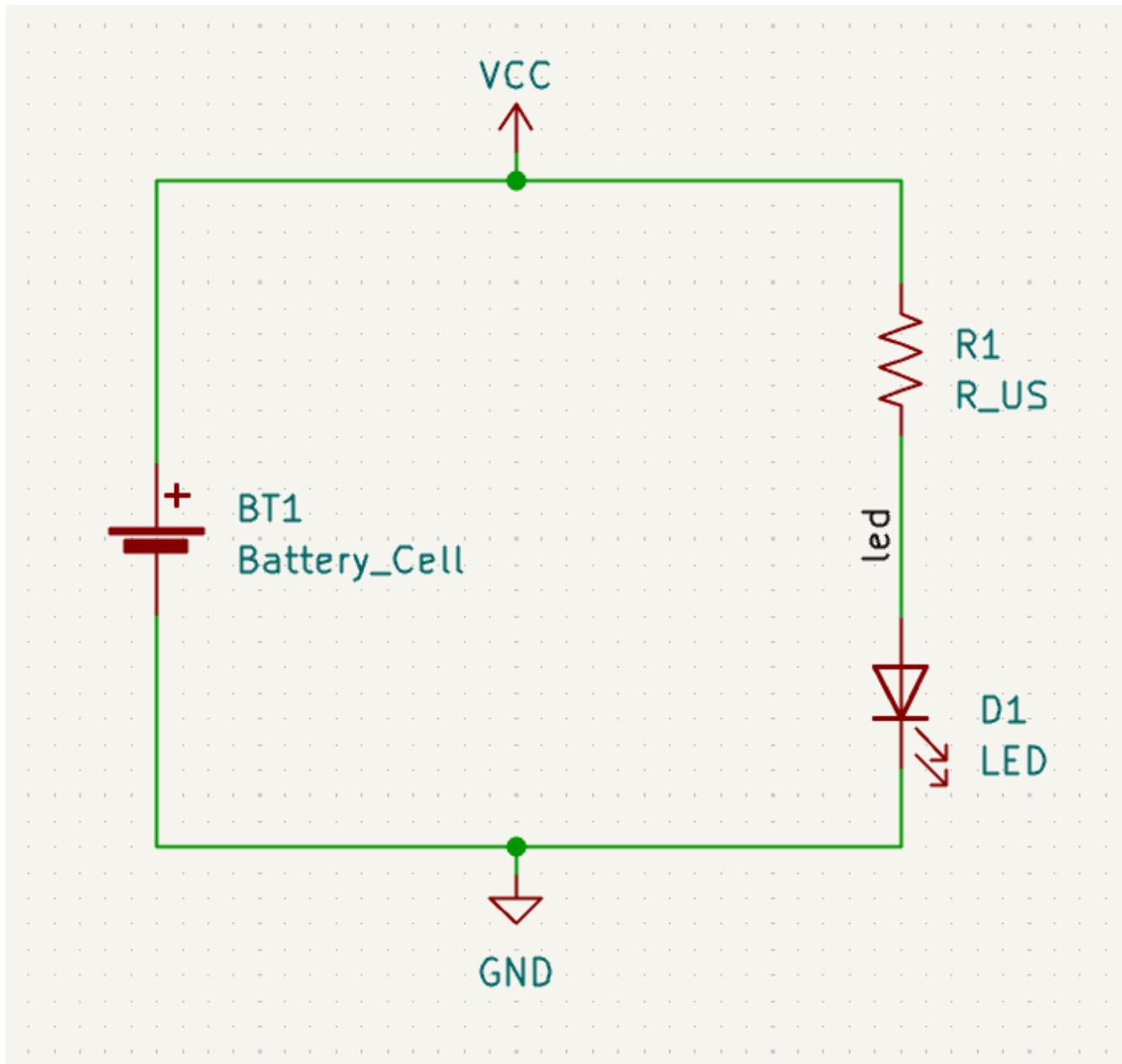
请注意，同名的标签和电源符号是连接在一起的。在这个原理图页面上，另一个 GND 符号或标记为 `led` 的导线将与现有的导线短路，即使没有导线将它们直观地连接起来。
