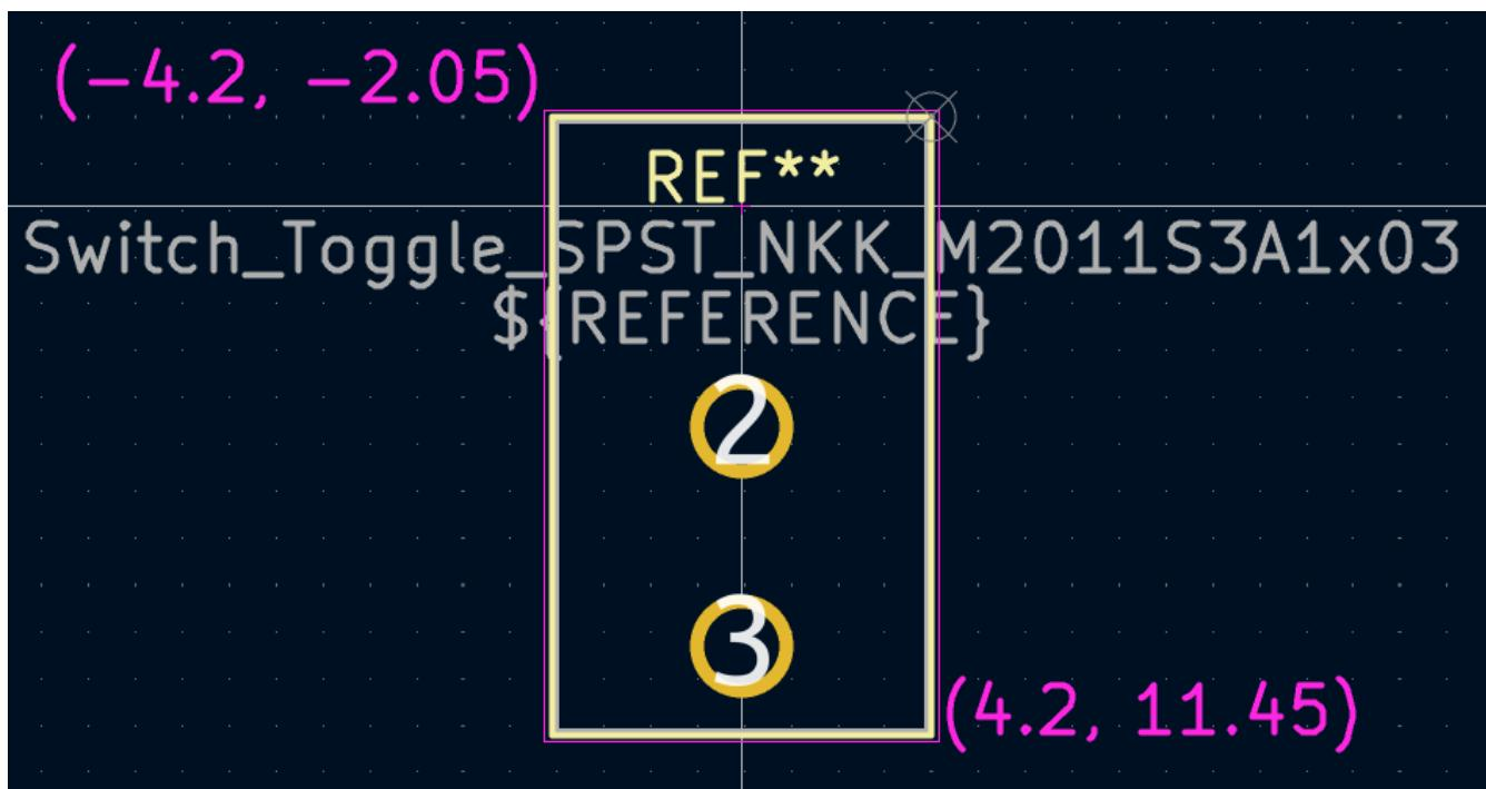
完成边框后，将文字定位如下图所示。封装就完成了。
