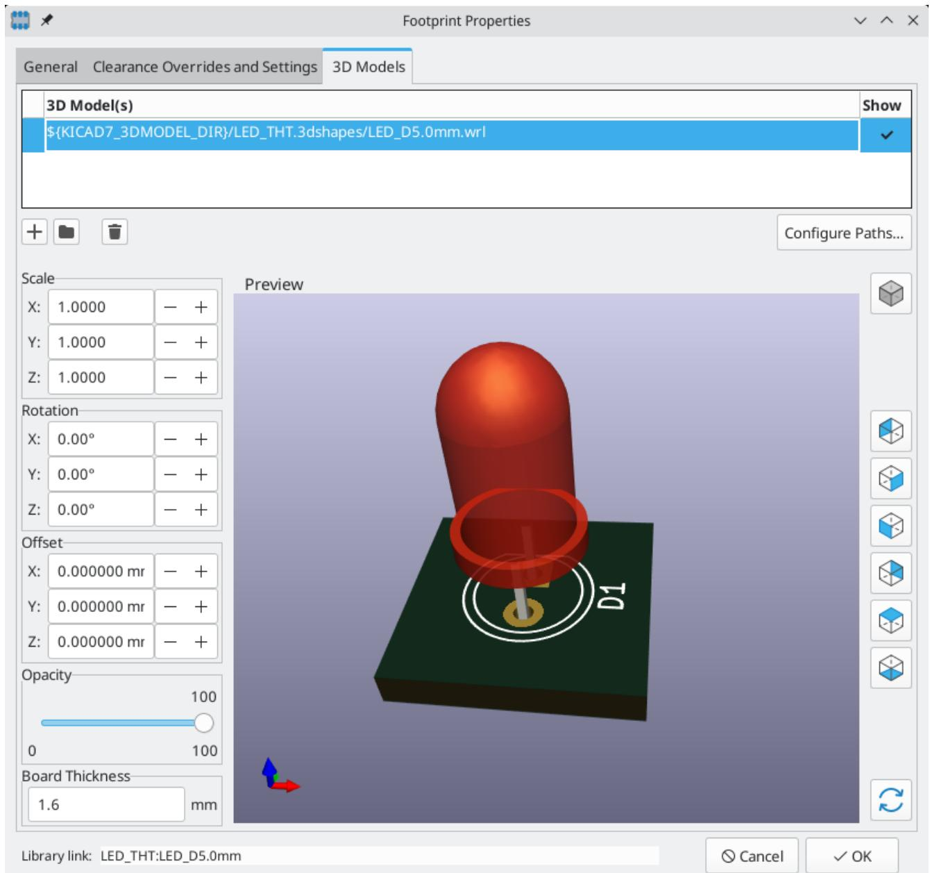
支持 STEP（.step）和 VRML（.wr1）两种 3D 模型格式。STEP 文件在需要尺寸精度的情况下非常有用，而 VRML 文件可以用来制作更具视觉吸引力的渲染图。KiCad 库中的许多封装都有相关的 3D 模型；这些模型都以 VRML 和 STEP 格式提供。两种模型中只有一种需要在封装中列出（通常是给出 VRML 文件名）。在为机械 CAD 目的导出电路板的 3D 模型时，KiCad 可以自动替换 STEP 版本。
