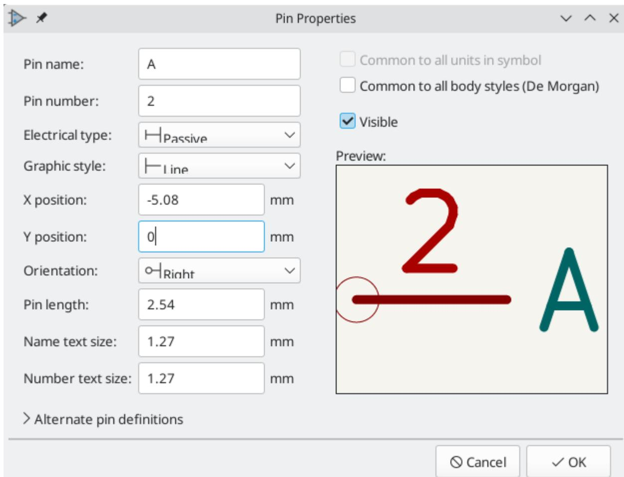
添加第二个引脚，但这次不要使用 **添加引脚** 工具。相反，按 **Insert**。一个编号为 3 的新引脚被添加到符号中，就在引脚 2 下面。
