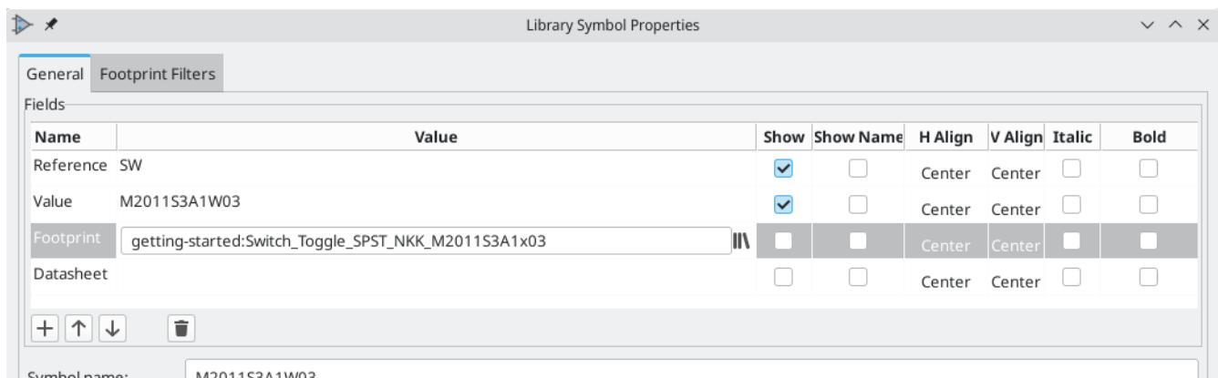
符号可以指定一个预选的封装。封装不需要手动分配给这些符号，因为在创建符号的时候就已经选择了一个封装。用户可以在封装分配过程中正常覆盖预选的封装。定义一个默认的封装对于那些通常或总是被分配相同封装的符号来说是个好主意，例如一个只在一个包中可用的元件。开关封装《默认封装，被设置为其匹配符号的默认封装》
