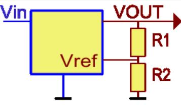
Per il *Tipo standard*, la tensione in uscita  $V_{out}$ , funzione della tensione di riferimento  $V_{ref}$  e delle resistenze  $R1$  e  $R2$ , è data da:
