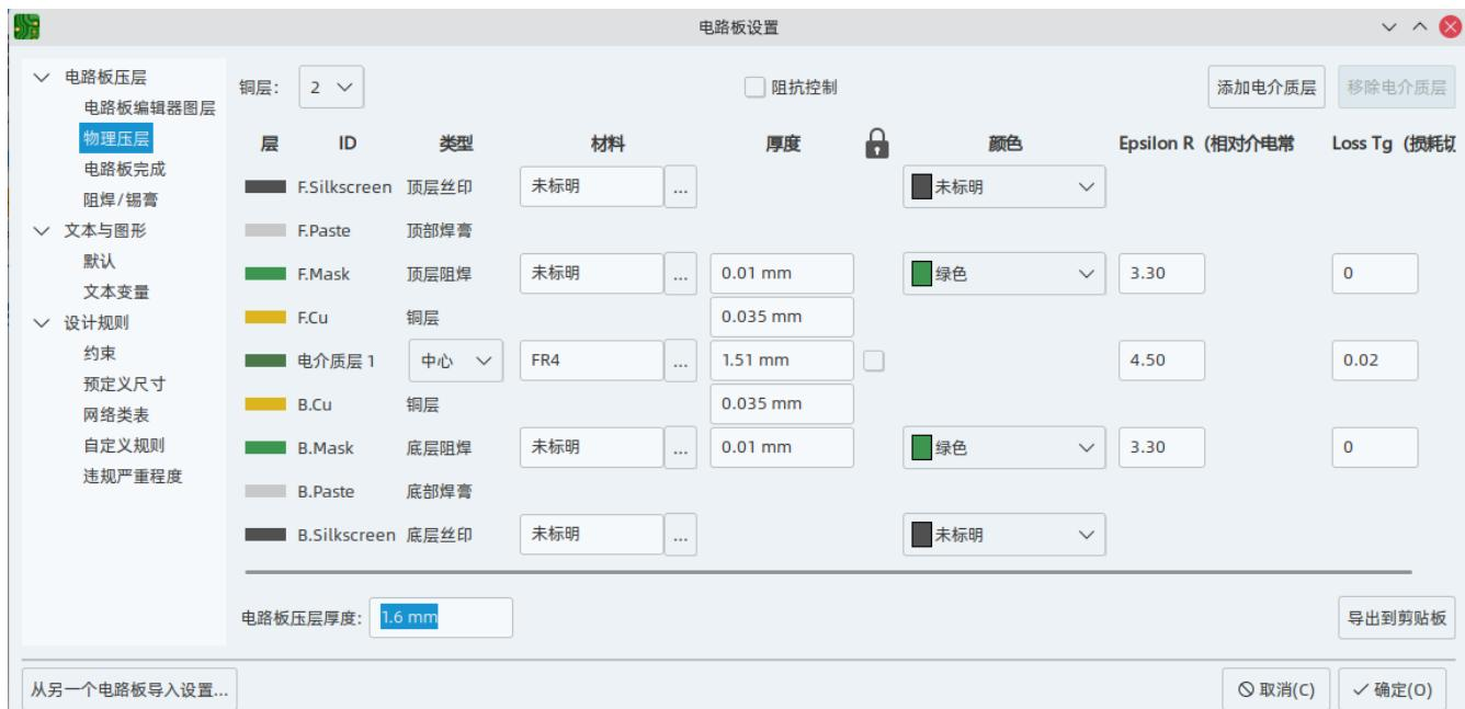
在左上角设置铜层的数量，然后根据需要输入压层的物理参数。这些参数可以保留其默认值，但请注意，在导出电路板的 3D 模型时，将使用电路板的厚度值，所以如果你打算使用这个功能，最好确保压层厚度是正确的。
