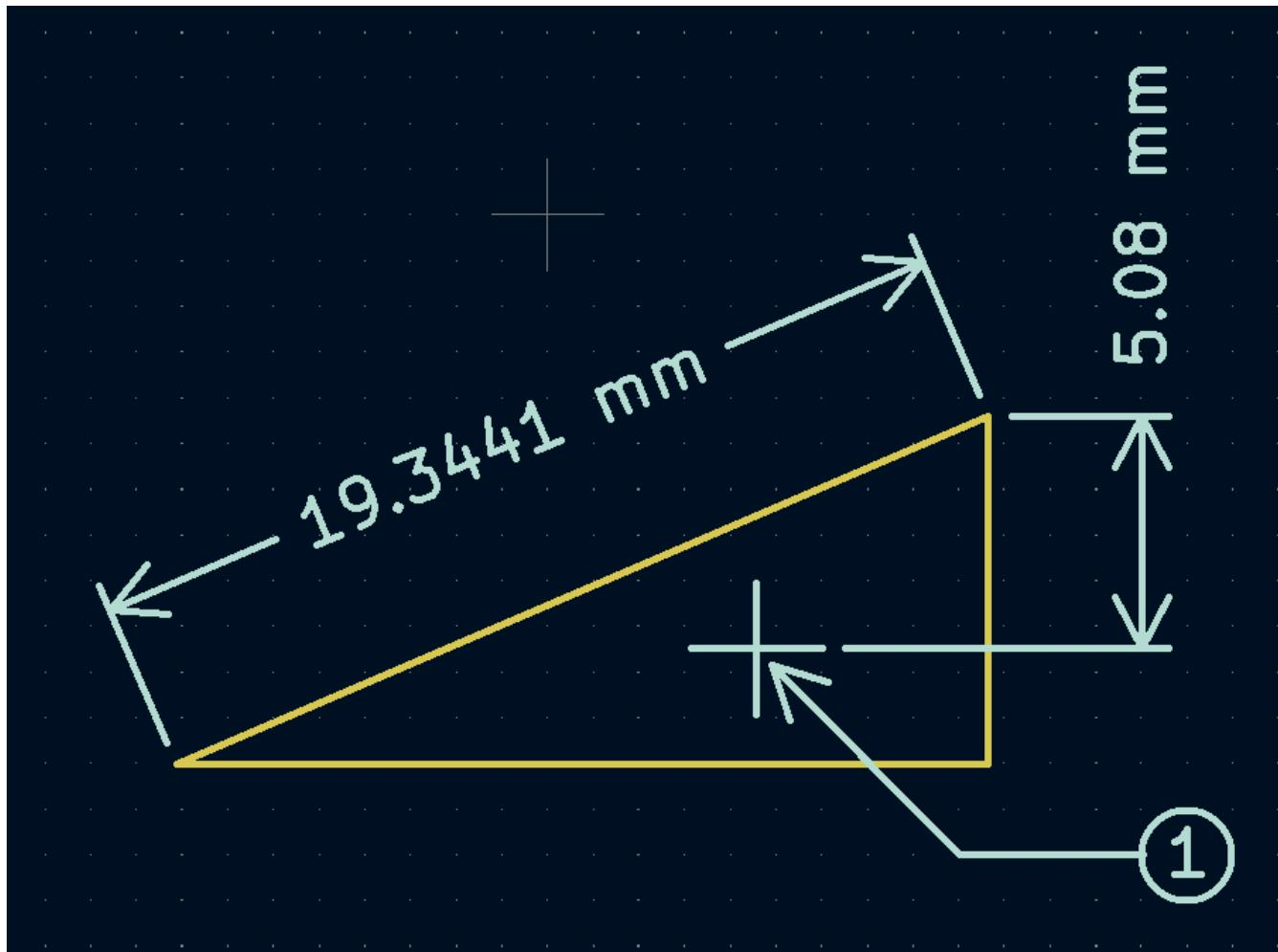
创建一个标注后，可以编辑其属性（热键 **E**）以改变显示数字的格式以及文本和图形线的风格。
