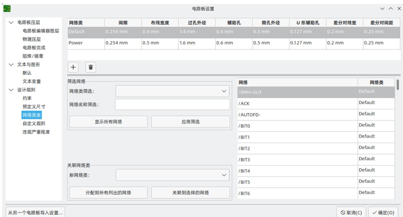
网络类部分的上部包含一个表格，显示了适用于每个网络类的设计规则。每个网络类都有铜间隙、布线宽度、过孔尺寸和差分对尺寸的值。这些值将在创建布线和过孔时使用，除非有更具体的规则覆盖它们（见下面的自定义规
