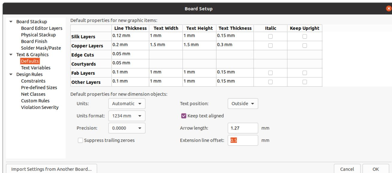
可以为对话框中显示的六种不同类别的图层配置线粗细、文字大小和文字外观。此外，可以为所有图层配置标注对象的特性。有关标注属性的更多详细信息，请参阅下面的标注部分。
