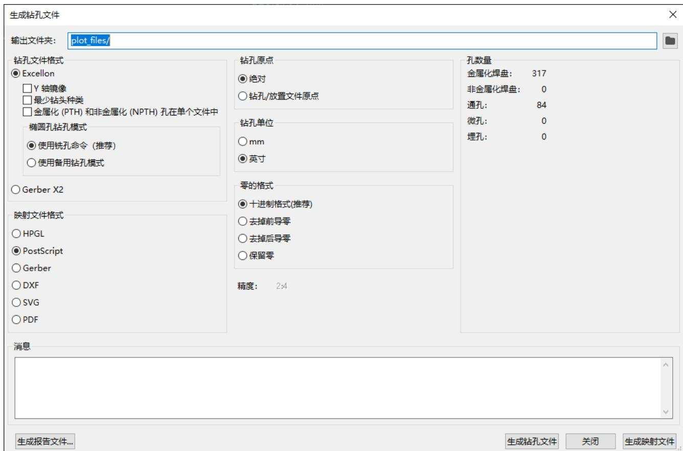
**输出文件夹:** 选择要保存生成的钻孔和映射文件的文件夹。如果输入相对路径，则它将相对于工程目录。
