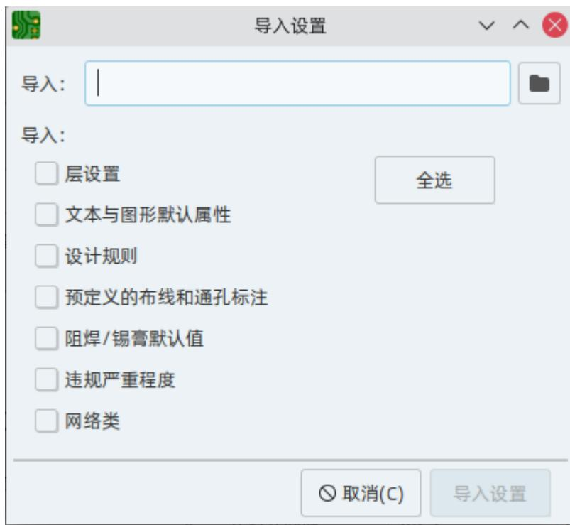
要导入设置，请点击电路板设置对话框底部的“从另一个电路板导入设置...”按钮，然后选择您要导入的 kicad\_pcb 文件。选择你想导入的设置，当前的设置将被选定的板子的值覆盖。
