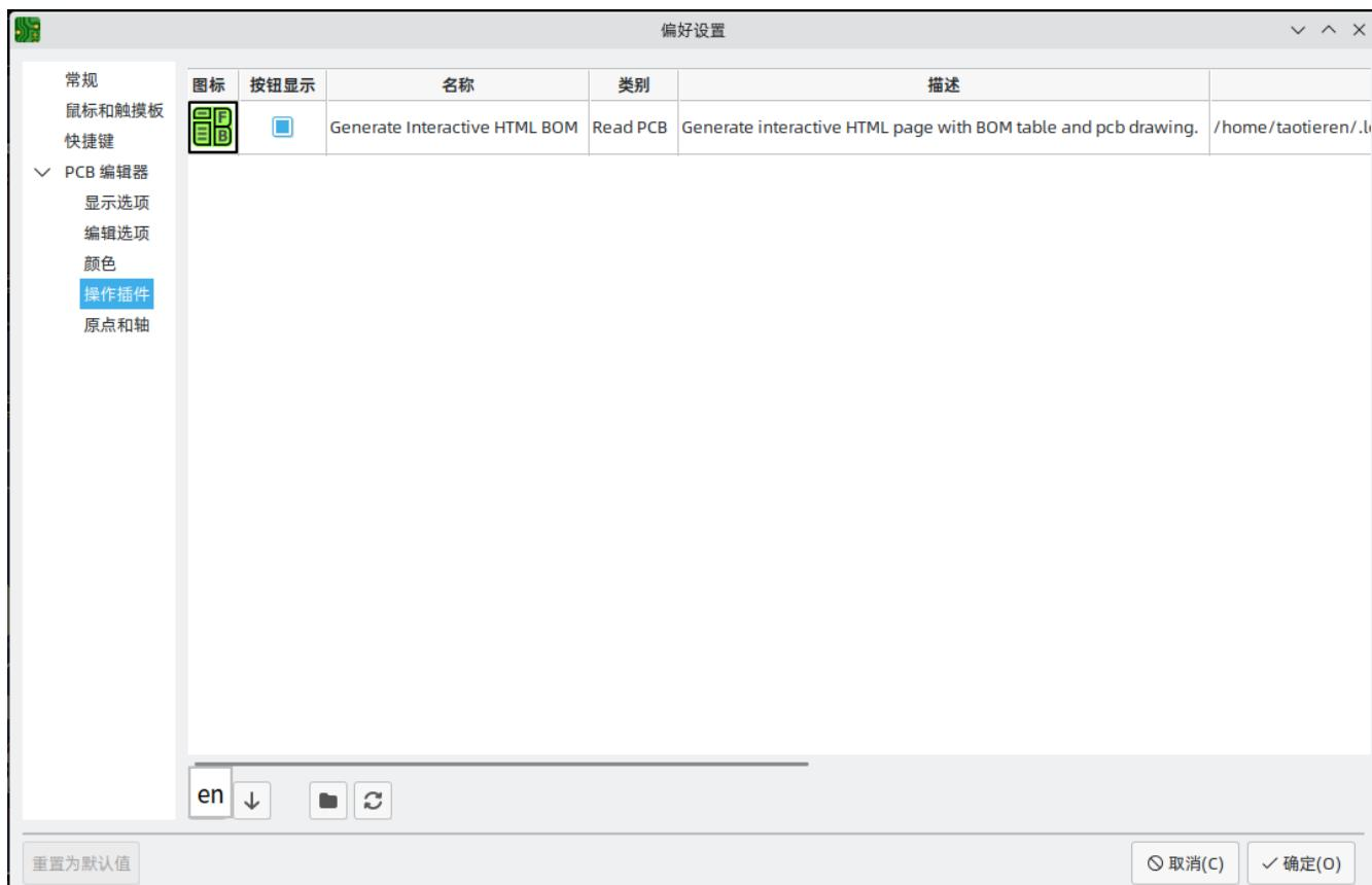
KiCad PCB 编辑器支持用 Python 编写的插件，可以对正在编辑的电路板进行操作。这些插件可以使用内置的插件和内容管理器来安装（详见 KiCad 章节），或者将插件文件放在用户的插件目录中。详见下面的脚本部分。
