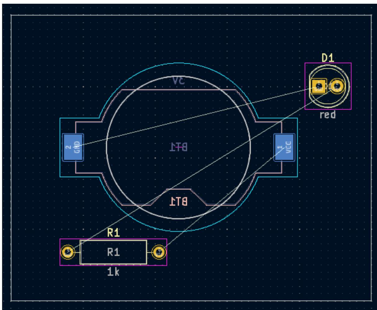
Tutti gli strati del C.S. sono visualizzati dal lato fronte della scheda. Le impronte sul fondo del tabellone sono quindi capovolte e appaiono specchiate.
