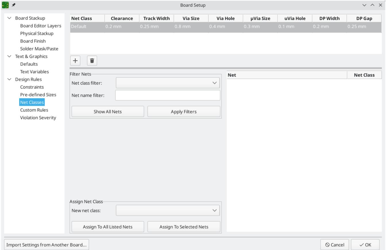
Track width and spacing can be managed manually by the designer during layout, but net classes are recommended because they provide an automatic way to manage and check design rules. < Larghezze e spaziature piste possono essere gestite manualmente dal progettista durante la stesura del C.S., ma l'uso delle netclass è consigliato perché forniscono un modo automatico per gestire e controllare le regole di progettazione.
