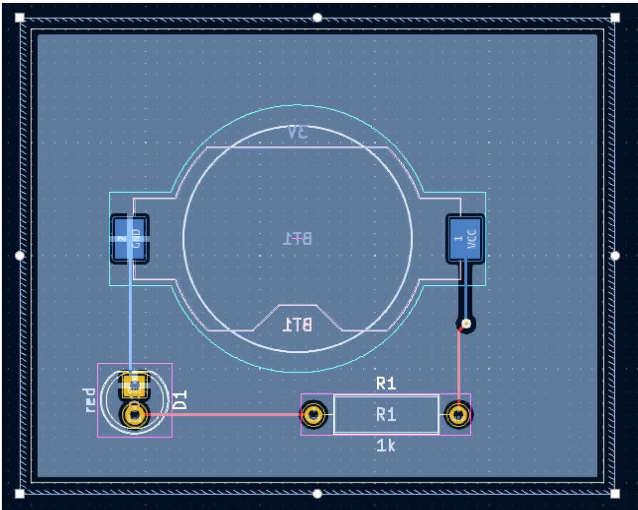
In KiCad, le zone non vengono riempite automaticamente quando vengono disegnate o modificate per la prima volta, o quando le impronte al loro interno vengono spostate. Le zone vengono ricaricate riempiendole manualmente e durante l'esecuzione di **DRC**. Assicurarsi che i riempimenti delle zone siano aggiornati prima di generare [i file necessari alla fabbricazione](#).
