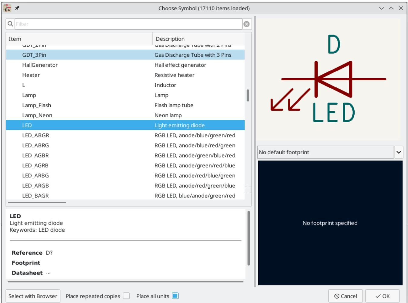
Quindi, aggiungere una resistenza di limitazione di corrente. Tornare al selettore dei simboli, ma questa volta provare a cercare una resistenza inserendo "R" nella casella del filtro in alto. Di nuovo, si trova nella libreria `Device`. Il dispositivo `R` è un simbolo di resistenza rettangolare in stile IEC. Un simbolo `R_US` è disponibile anche per gli utenti che preferiscono il simbolo a zigzag in stile ANSI. Selezionare un simbolo di resistenza e aggiungerlo allo schema.
