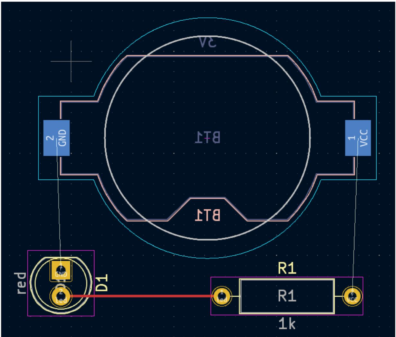
Ora disegnare una pista tra le piazzole GND di BT1 e D1, iniziando con la piazzola BT1 sul retro dello stampato. Notare che lo strato attivo è cambiato automaticamente in B.Cu dopo aver fatto clic sulla piazzola BT1. Fare clic sulla piazzola D1 per terminare la pista.
