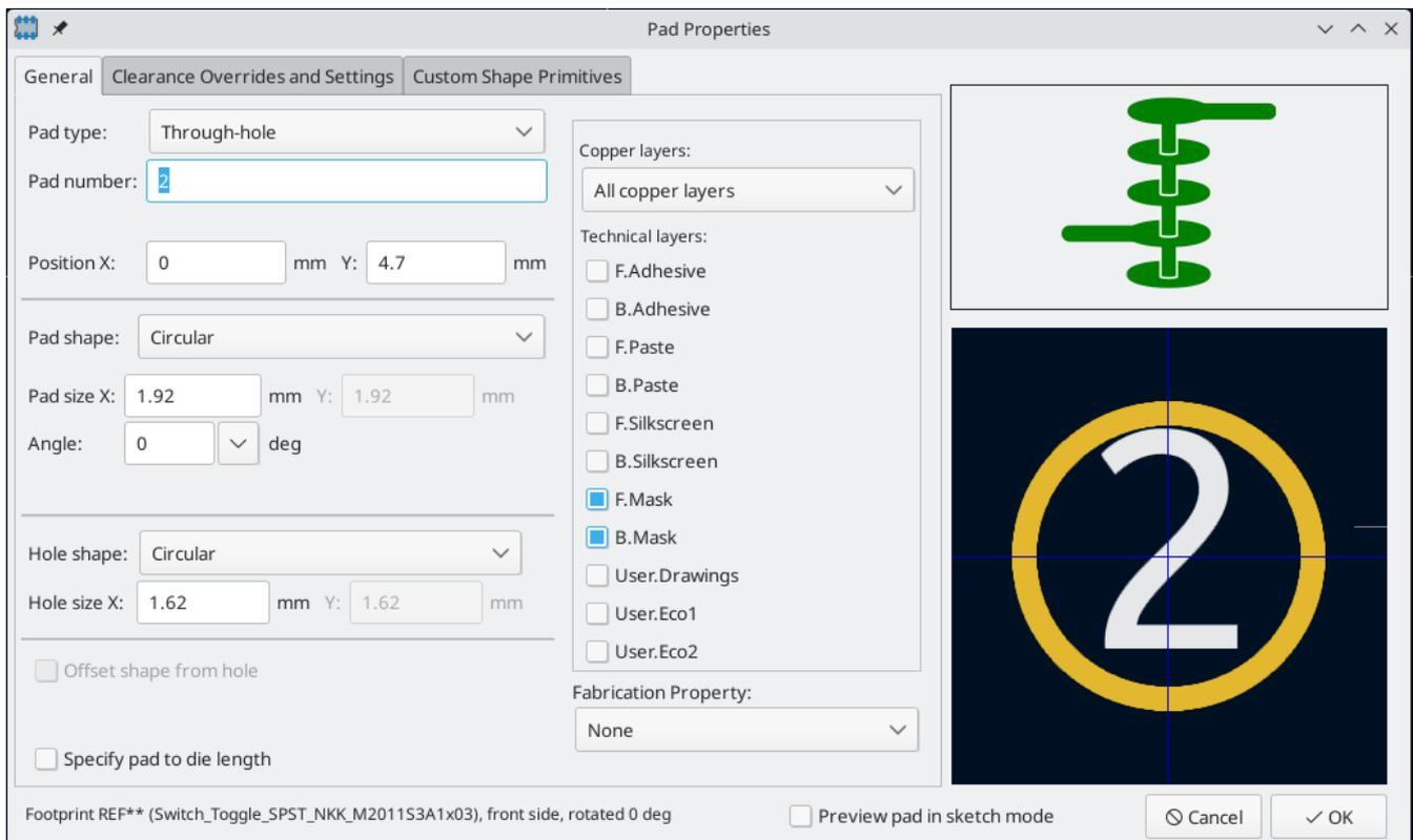
Ora usare nuovamente lo strumento **Aggiungi piazzola** per posizionare l'altra piazzola a (0, 9,4 mm). Si noti che il numero piazzola viene incrementato automaticamente e le proprietà, incluse la dimensione della piazzola e la dimensione del foro, vengono copiate dalla piazzola precedente.
