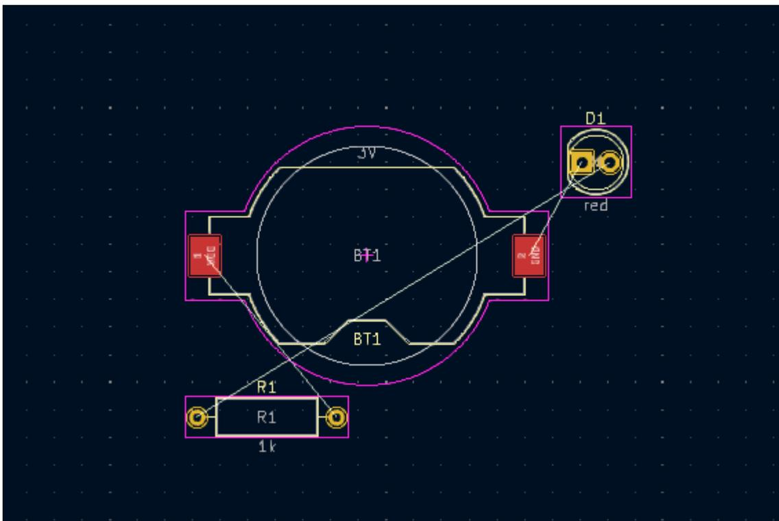
In KiCad, l'aggiornamento del C.S. con le modifiche allo schema è un processo manuale: il progettista decide quando è opportuno aggiornare il C.S. con le modifiche allo schema. Ogni volta che lo schema viene modificato, il progettista deve utilizzare lo strumento **Aggiorna il C.S. dallo schema** per mantenere lo schema e il layout sincronizzati.
