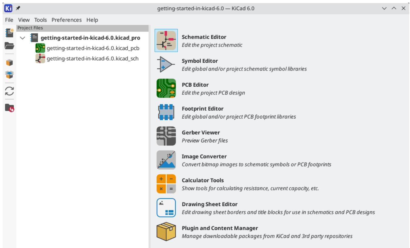
A sinistra, il riquadro `File progetto` elenca i file nel nuovo progetto. C'è un file progetto con estensione `.kicad_pro`, un file schema con estensione `.kicad_sch` e un file circuito stampato con estensione `.kicad_pcb`. Questi file condividono tutti lo stesso nome del progetto.
