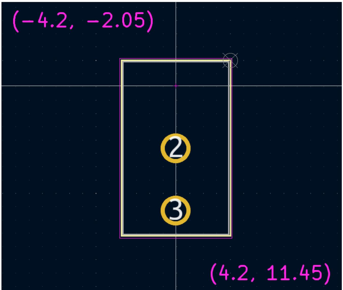
Dopo aver completato i contorni, posizionare il testo come mostrato di seguito. L'impronta ora è completa.
