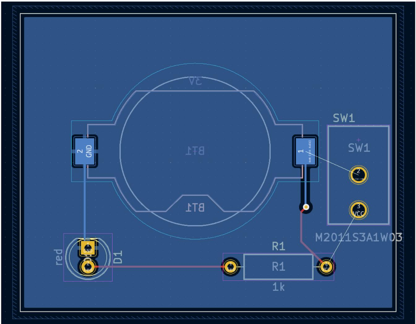
La ratsnest mostra le nuove connessioni che devono essere sbrogliate. Inoltre, è necessario eliminare il collegamento tra la batteria e la resistenza.
