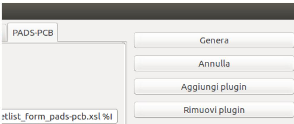
I nuovi generatori richiedono un nome e un comando. Il nome viene mostrato nell'etichetta della scheda e il comando viene eseguito ogni volta che si fa clic sul pulsante **Esporta netlist**.
