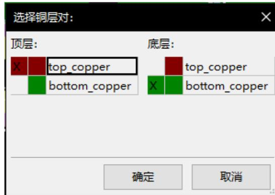
当放置过孔时，工作（有源）层自动切换到用于过孔的层对的交替层（除非在添加过孔时保持“移位”）。也可以通过热键切换到另一个活动层，如果正在进行跟踪，则会插入一个过孔。
