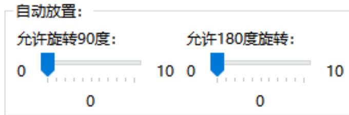
通常，电阻器，非极化电容器和其他对称元件允许旋转 180 度。
