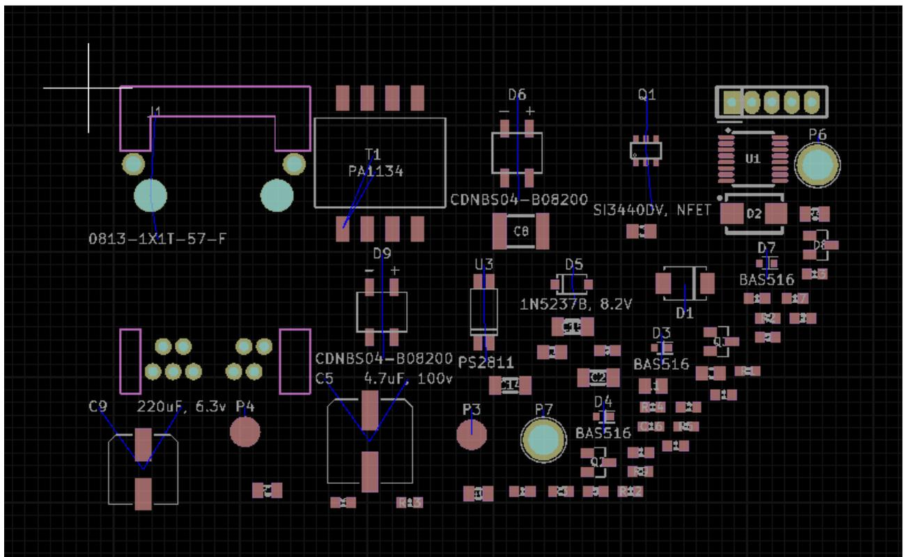
使用遗留后端，当在网表文件中找到新的封装时，它们将被自动加载并放置在坐标 (0,0) 处。
