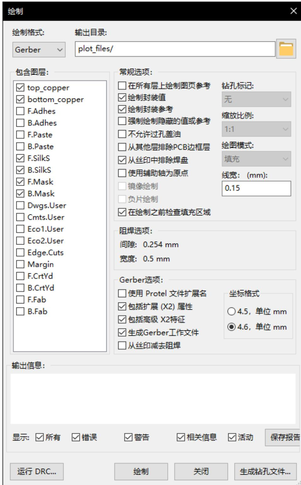
通常，文件采用 GERBER 格式。然而，可以以 HPGL 和 POSTSCRIPT 格式生成输出。选择 Postscript 格式后，将出现此对话框。
