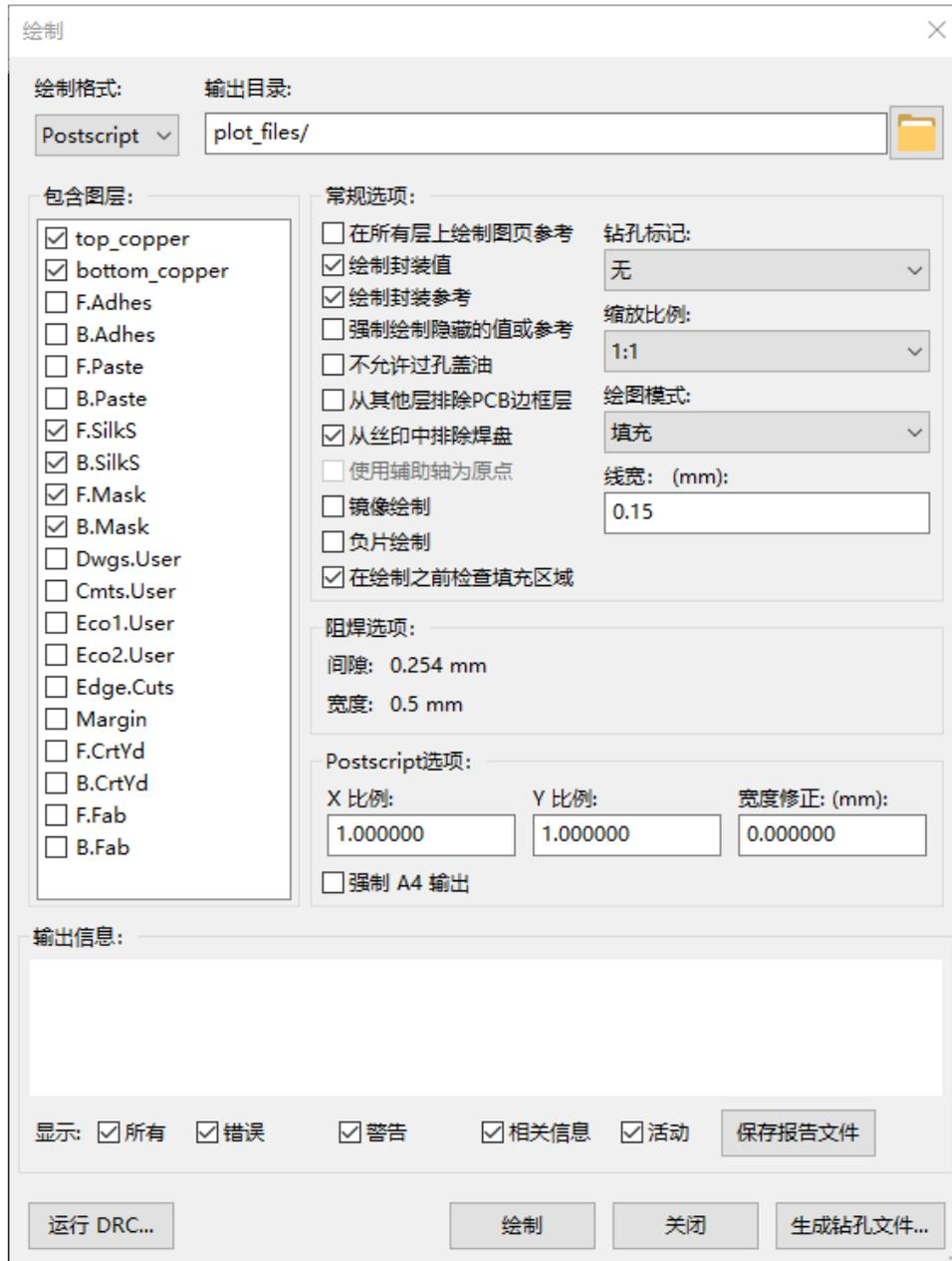
在这些格式中，可以使用精细刻度调整来补偿绘图仪的精度，并使输出的真实比例为 1:
