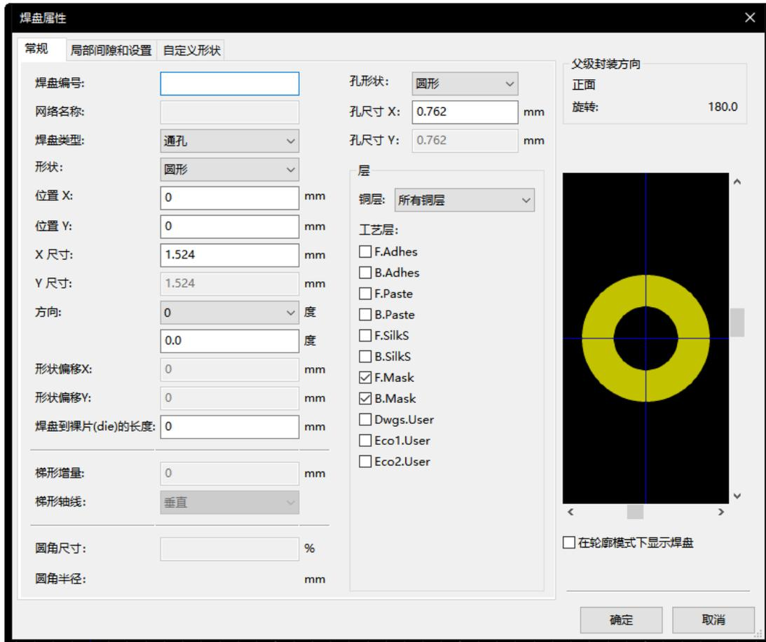
应注意正确定义焊盘所属的层。特别是，尽管铜层易于定义，但非铜层（阻焊层，焊盘……）的管理对于电路制造和文档记录同样重要。
