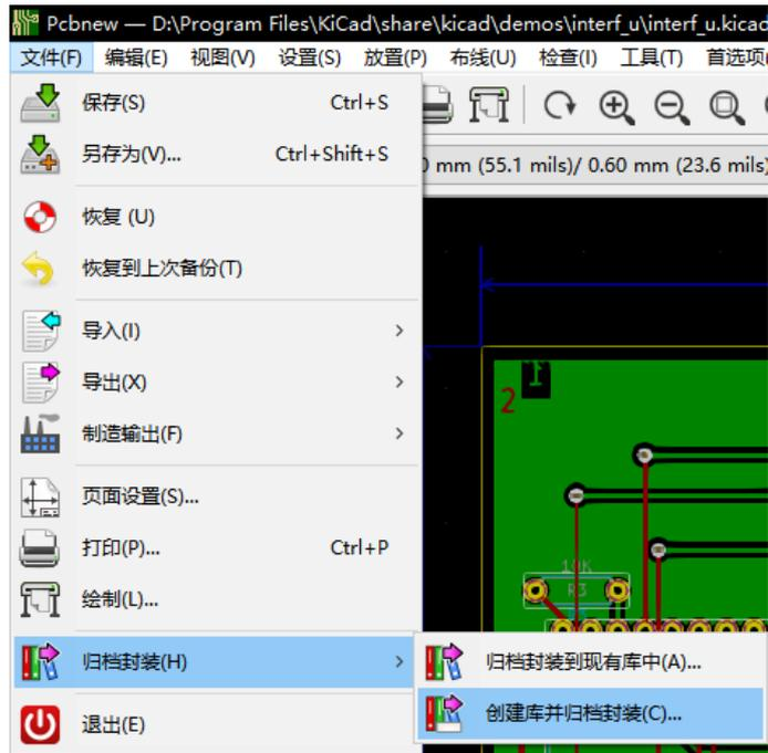
因此，库的“真实来源”将是辅助电路板，并且在该电路板上将进行任何随后的封装改变。当然，几个电路板可以保存在同一个库中。
