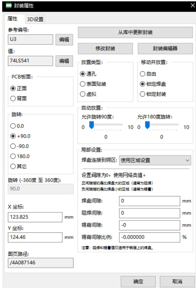
在这种情况下，电路板的活动封装将自动加载到“封装编辑器”中，从而可以立即进行编辑或存档。
