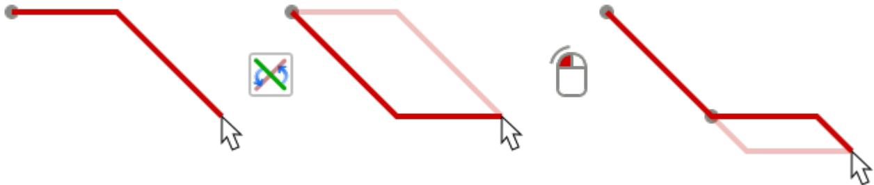
在非传统画布中布线时按住“Ctrl”会将布线限制为单个水平或垂直段。切换样式变为单个差分对线段。在路由时按住“Shift”可以移除“捕捉到对象”的重力。
