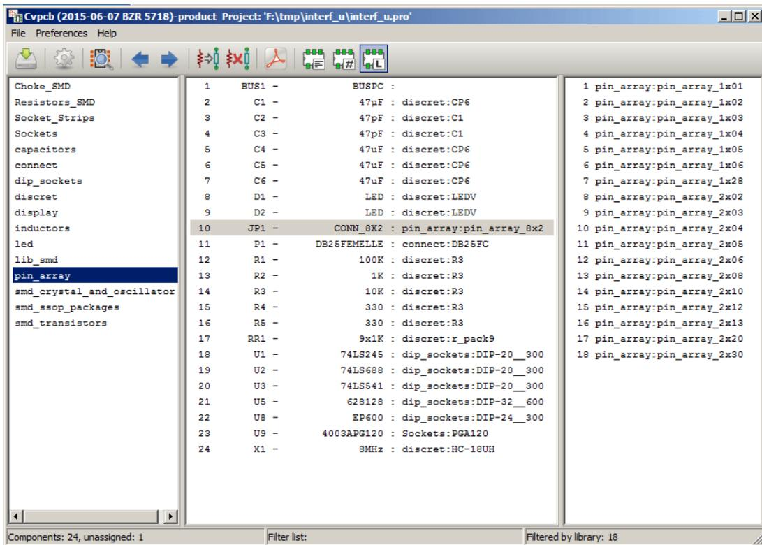
不同的过滤器可以叠加作用, 实现复杂的过滤需求. 这可以帮助减少右侧窗格中的封装数目, 方便查询.
