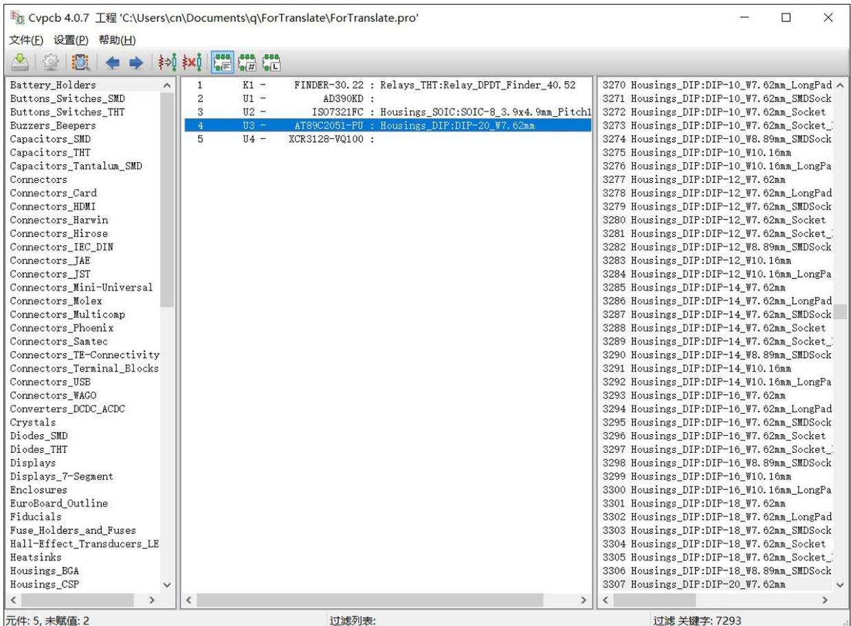
在主界面中, 左窗格包括了所有与项目关联的可用的封装库文件名列表; 中间窗格包括了从网络文件中读入的所有元器件列表; 右窗格包括了所有从与项目关联的封装库中加载的可用的封装列表。如果没有加载网络文件, 那么元器件列表将是空的; 类似的, 如果没有找到可用的封装库, 那么位于右侧的封装列表也将是空的。
