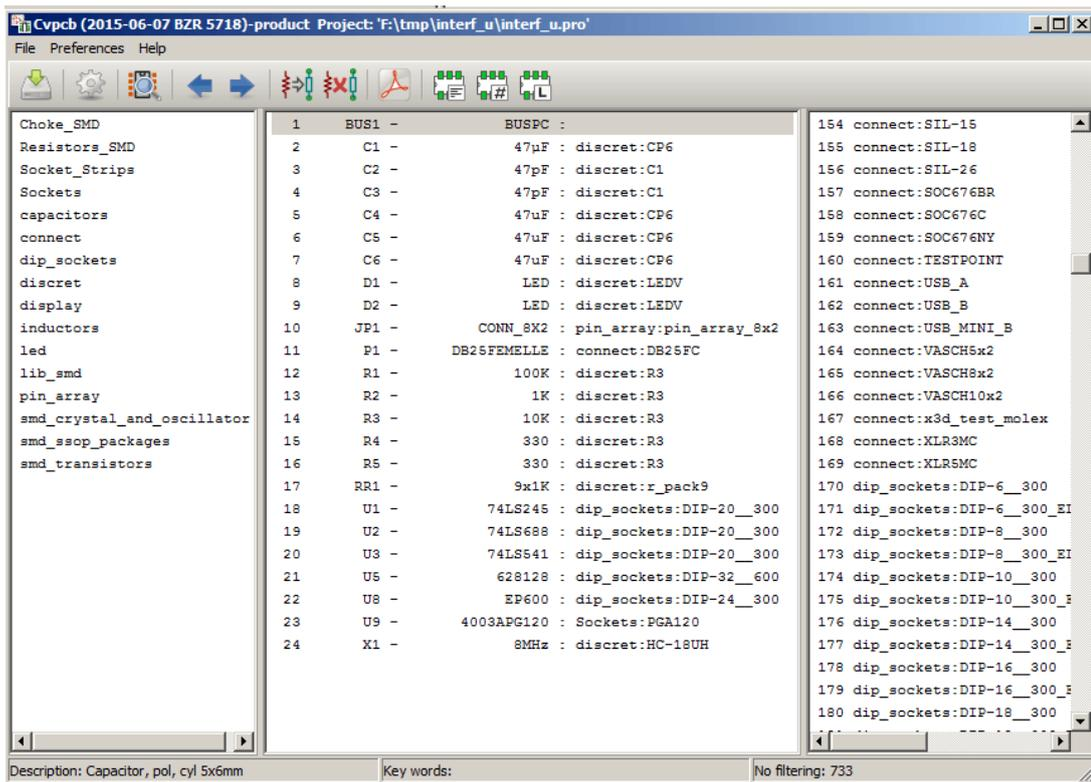
根据应用于选定元器件的过滤器对封装列表进行过滤. 选定元器件中启用的过滤器显示于主窗口底部的状态栏中部.
