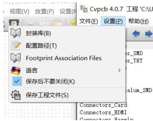
CvPcb 可以在保存封装关联关系后自动关闭或手动关闭。
