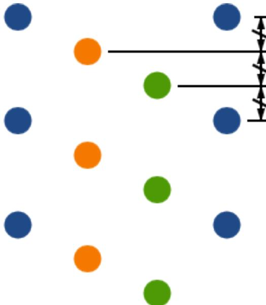
Рис. 13.3: Сетка 4x3 с шахматностью в столбцах равной 3
