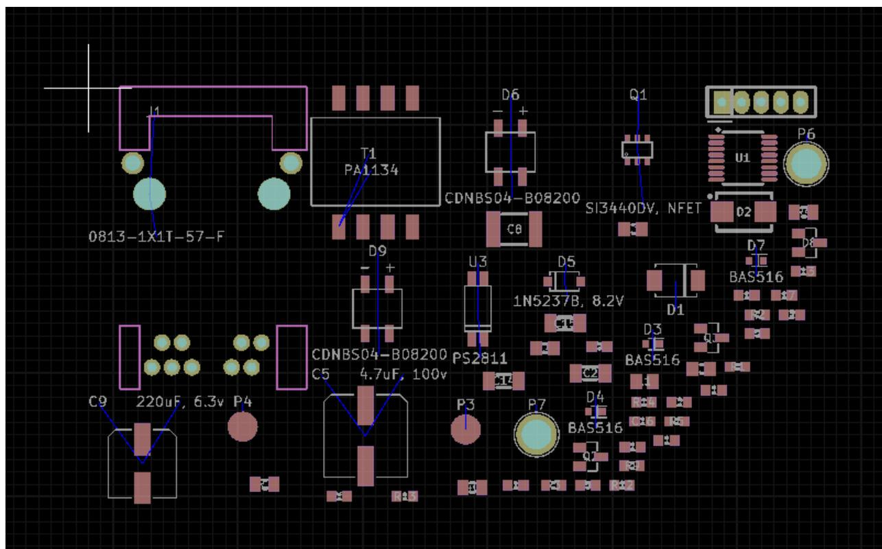
При обнаружении новых посадочных мест в списке цепей в стандартном режиме отображения, они будут автоматически загружены и размещены в точке с координатами (0,0).
