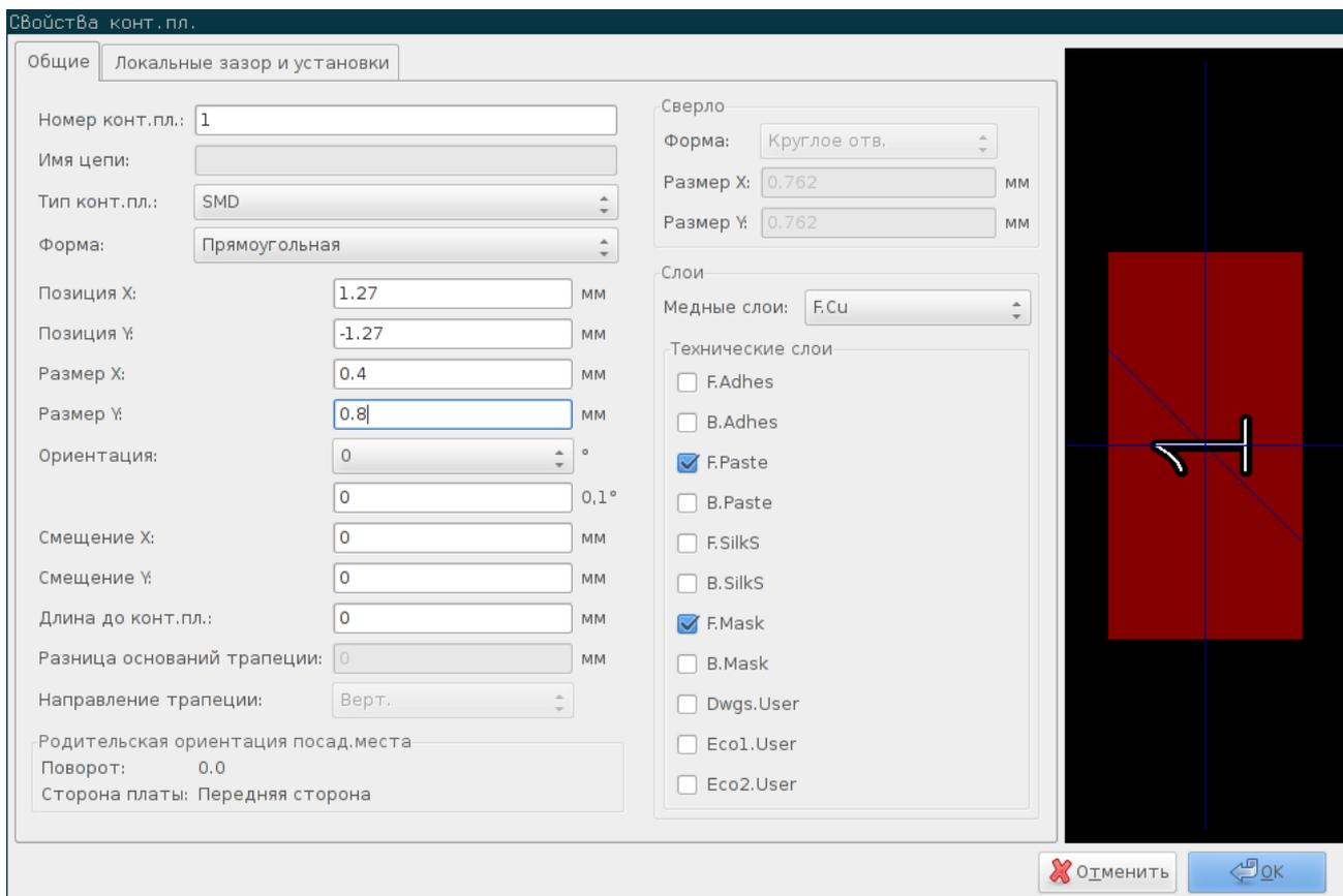
5. Установите *Номер контактной площадки – 1*, *Форма контактной площадки – Прямоугольник*, *Тип контактной площадки – SMD* (планарная), *Размер контактной площадки X – 0.4*, *Y – 0.8*. Нажмите ОК. Снова нажмите кнопку *Добавить контактную площадку* и добавьте ещё две контактные площадки.
