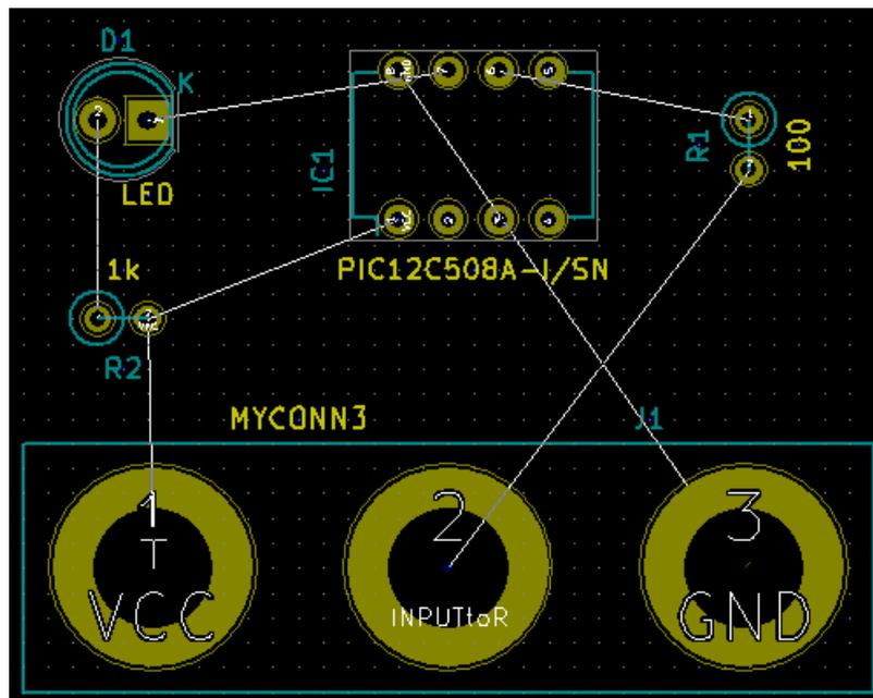
10. Заметьте, что один контакт 100-омного резистора соединён с шестым выводом компонента PIC. Это результат использования метода маркировки, применённого при соединении контактов. Метки часто предпочтительнее реальных проводников, потому что они делают схему более аккуратной.
