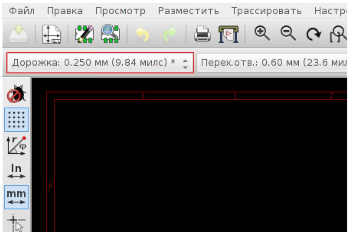
16. Если понадобится больше значений для ширины дорожек, пройдите **Установки** → **Правила проектирования** → **Общие правила проектирования** и в правом нижнем углу этого окна добавьте любое другое нужное значение ширины. После этого станет возможным изменять значение ширины дорожек из выпадающего меню во время разводки платы.
