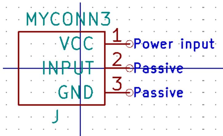
8. Если потребуется закрасить прямоугольник, например, желтым цветом, нужно выбрать его и изменить свойства (клавиша [e]), а именно, установить **Стиль заливки** в *Заливка фона*. Затем в Eeschema открыть **Настройки** → **Параметры редактора схем** → **Цвета** и для *Заливки фона* установить значение *Yellow 4*.
