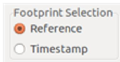
Con questa opzione, Pcbnew non identifica più le impronte dai riferimenti, ma dalle marcature temporali. Le marcature temporali sono automaticamente generate da Eeschema (è la data e l'ora di quando il componente è stato inserito nello schema).
