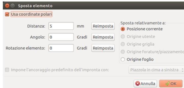
La casella di selezione permette di passare dal sistema di coordinare cartesiane a quello polare. Il valore correntemente inserito viene convertito automaticamente da un sistema all'altro.
