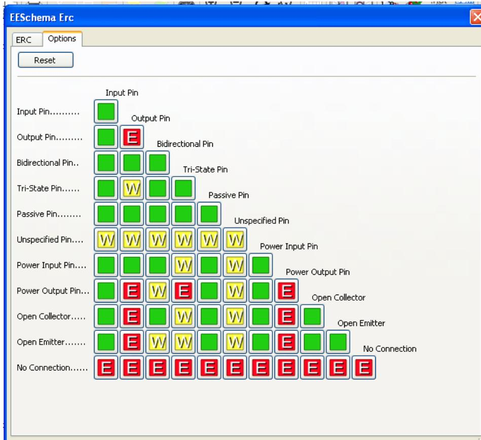
Aturan dapat diubah dengan melakukan klik pada kotak yang diinginkan pada matriks. Pilihan yang tersedia adalah *normal*, *warning*, dan *error*.
