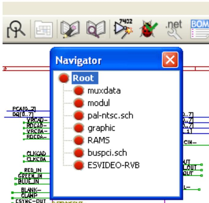
Untuk memilih lembar kerja, klik pada nama lembar kerja tersebut. Untuk membuka, klik-kanan pada nama lembar kerja, dan pilih *Enter Sheet* atau klik-ganda dalam batas lembar kerja.
