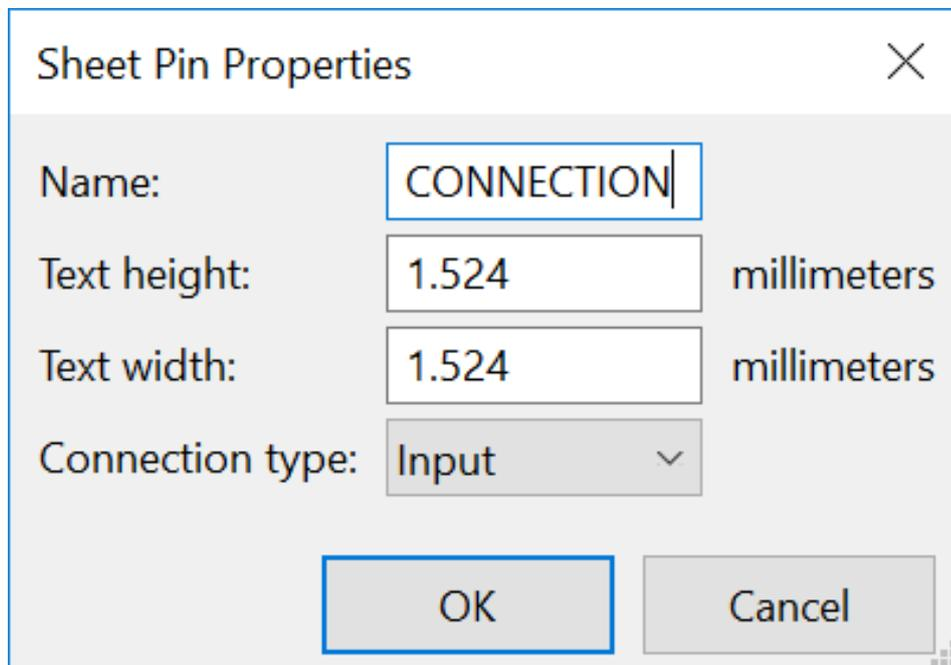
Anda bisa menentukan nama, ukuran dan arah pin pada saat pembuatan atau nanti, dengan klik-kanan pada pin dan pilih "Edit Sheet Pin" pada menu *pop-up*.
