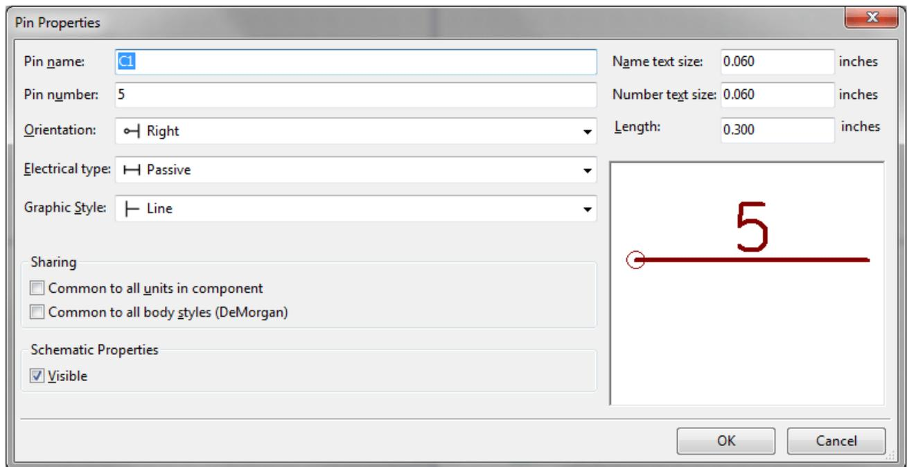
Kotak dialog properti pin digunakan untuk mengedit karakteristik dari sebuah pin. Kotak dialog ini akan muncul secara otomatis ketika Anda membuat sebuah pin atau melakukan klik-ganda pada pin yang sudah ada. Kotak dialog ini dapat digunakan untuk mengubah:
