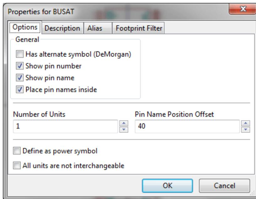
Sangat penting untuk mengisi jumlah bagian per paket dan representasi simbolis alternatif secara benar, jika diaktifkan, karena saat pin diedit atau dibuat, pin-pin yang terkait pada setiap bagian akan terkena efeknya. Jika Anda mengubah jumlah bagian per paket setelah membuat dan mengedit pin, maka akan ada pekerjaan tambahan untuk menambahkan pin-pin bagian dan simbol yang baru. Meskipun demikian, kita bisa mengubah nilai properti tersebut kapanpun.
