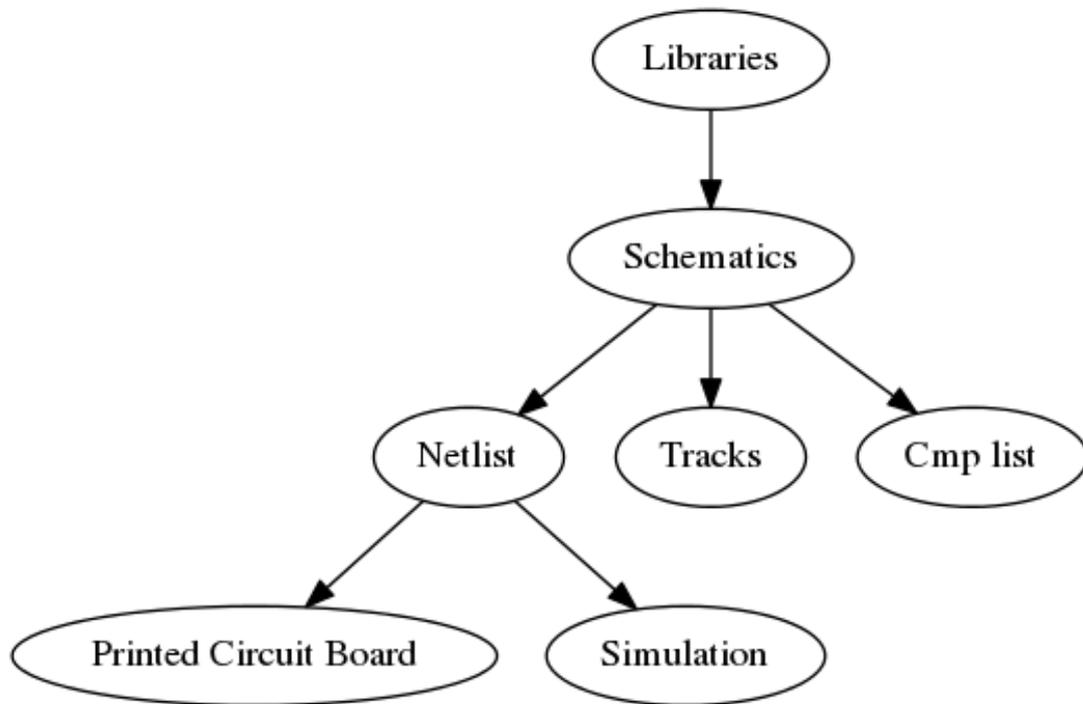
Simbol ditambahkan ke dalam skematik dari pustaka simbol. Setelah skematik selesai dibuat, akan dibuat sebuah *netlist*, yang nantinya akan digunakan untuk mengimpor koneksi dan *footprint* dari skematik ke PcbNew.
