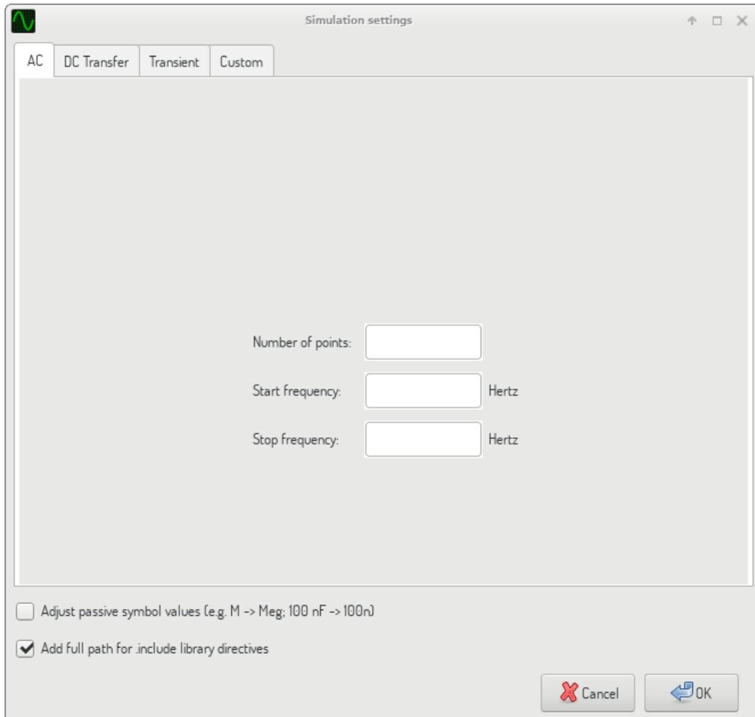
Kotak dialog pengaturan simulasi digunakan untuk mengatur tipe dan parameter-parameter simulasi. Ada empat tab pada kotak dialog ini:
