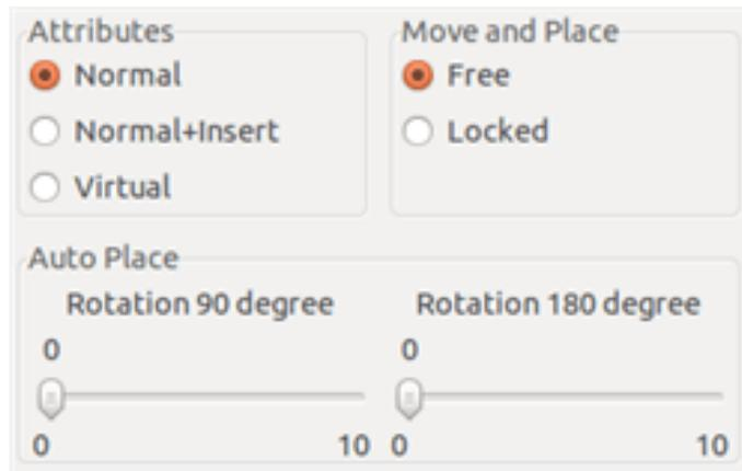
Habituellement, une rotation de 180 degrés est autorisée pour les résistances, les condensateurs non-polarisés et les autres composants symétriques.
