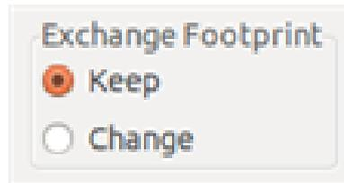
Le changement d'une empreinte (par exemple, le remplacement d'une résistance par une autre de taille différente), peut être effectué directement en éditant l'empreinte.
