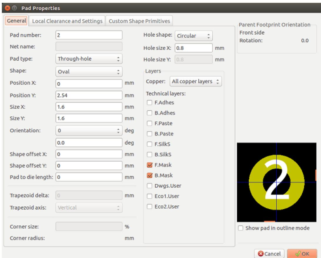
Un grand soin devra être pris pour définir correctement les couches auxquelles le pad appartiendra. En particulier, bien que les couches cuivre soient faciles à définir, la gestion des couches non-cuivre (masque de soudure, pâte à souder ...) est également importante pour la fabrication et la documentation du circuit.
