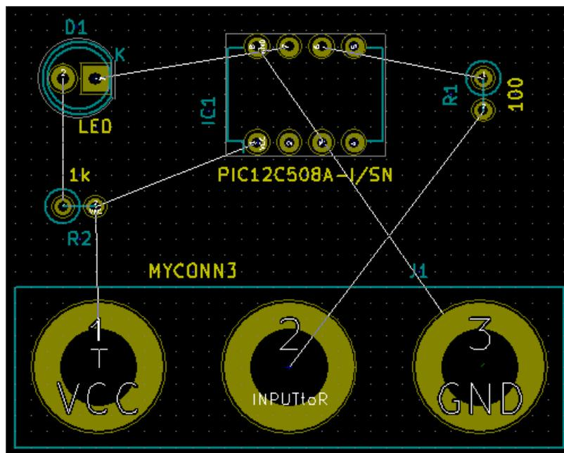
10. Remarquez qu'une des broches de la résistance de 100 ohms est connectée à la broche 6 du PIC. Ceci est le résultat de la méthode de connexion par étiquetage à l'aide de labels. Les labels sont souvent préférés aux fils car ils permettent de rendre le schéma plus lisible.
