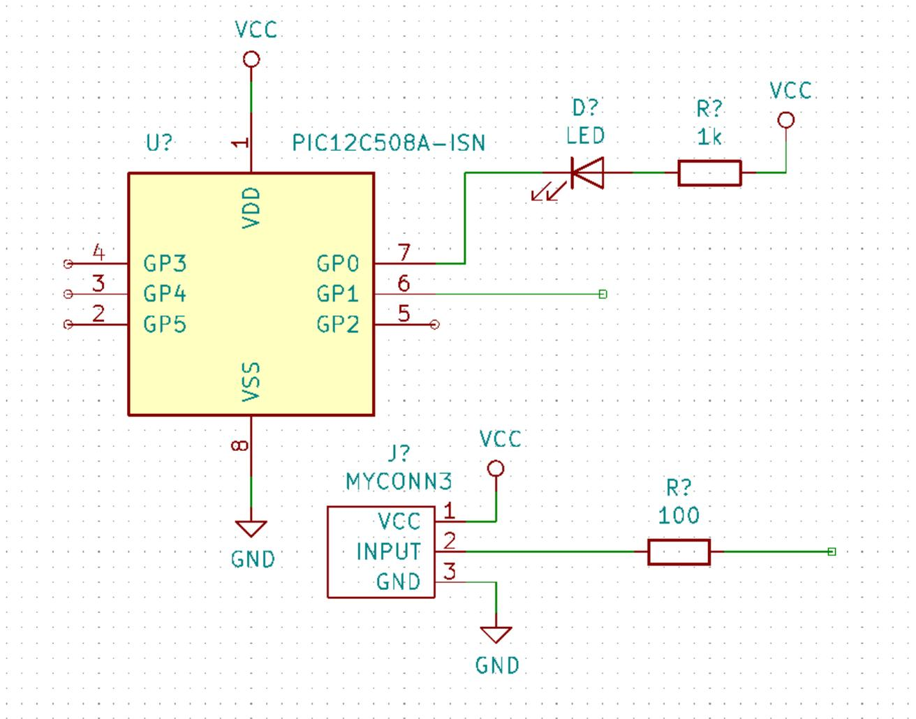
34. Voyons maintenant une autre façon de réaliser une connexion en utilisant des étiquettes (labels). Cliquez sur l'icône *Placer un label local* **A** de la barre d'outils de droite. Vous pouvez aussi utiliser le raccourci [I].
