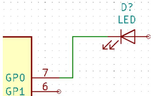
33. Répétez l'étape précédente et connectez tous les composants et alimentations comme indiqué ci-dessous. Un simple clic suffit pour terminer un fil si celui-ci est correctement positionné sur un élément permettant une connexion électrique. Un double clic est nécessaire pour interrompre un tracé et laisser le fil non connecté. Votre schéma devrait ressembler à l'image ci-dessous :
