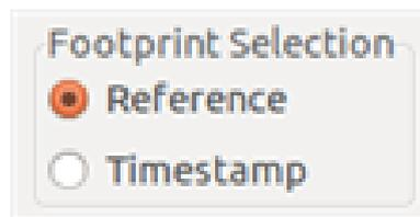
Mit dieser Option identifiziert Pcbnew Footprints nicht mehr über ihre Referenz, sondern über ihren Zeitstempel. Der Zeitstempel wird automatisch von Eeschema generiert (es ist die Zeit und das Datum, wann das Bauteil im Schaltplan hinzugefügt wurde).
