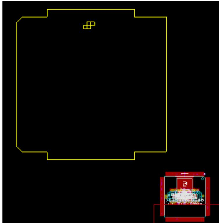
Wenn noch kein Footprint platziert wurde, werden alle Footprints an der gleichen Stelle auf der Leiterplatte eingefügt, was es schwierig macht, sie zu erkennen. Es ist möglich, sie automatisch anzuordnen über den Befehl *Global Spread and Place* aus dem Kontextmenü (rechte Maustaste; nur verfügbar wenn *Mode footprint* in der Hauptwerkzeugleiste aktiviert wurde). Hier sehen Sie das Ergebnis einer solchen Anordnung:
