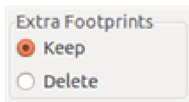
Wenn die Option "Zusätzliche Footprints" aktiviert ist, werden Footprints gelöscht, die zu einem Bauteil gehören, das nicht in der Netzliste gefunden wird, außer im Footprint ist die Option "Lock Footprint" gesetzt. Für "mechanische" Footprints ist es eine gute Idee, diese Option zu aktivieren:
