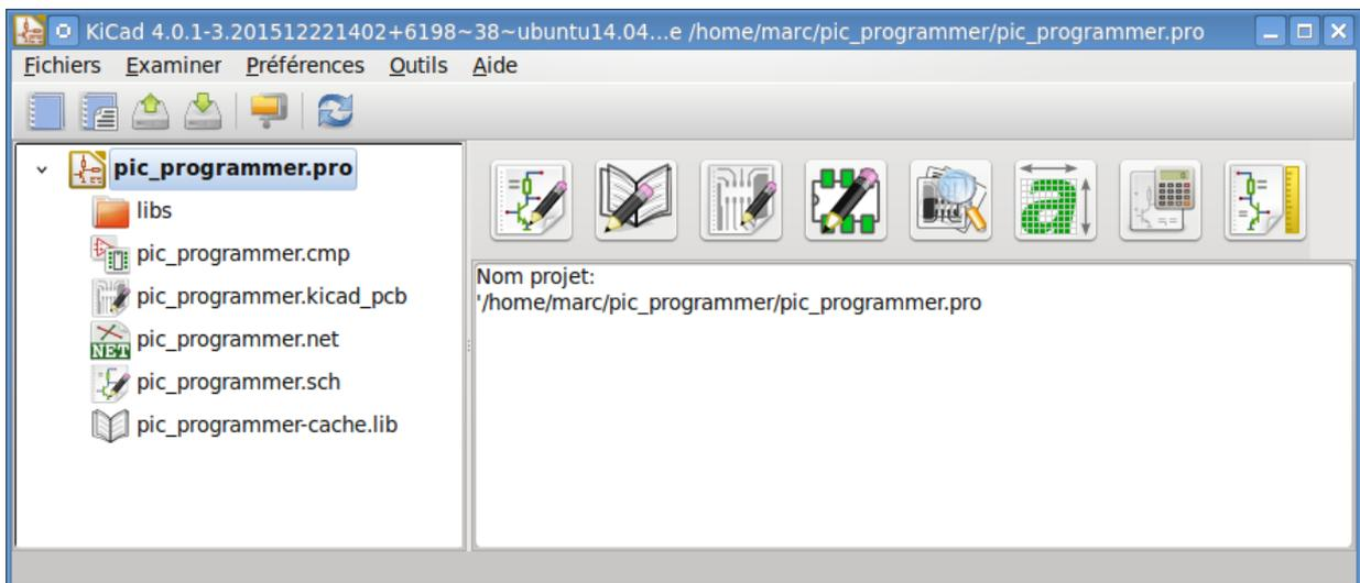
La fenêtre principale de KiCad est composée de l'arborescence du projet, d'une barre de lancement, munie de boutons, utilisée pour lancer les différents outils logiciels et utilitaires, et d'une fenêtre de messages. Le menu et la barre d'outils supérieure peuvent être utilisés pour créer, lire et enregistrer les fichiers du projet.
