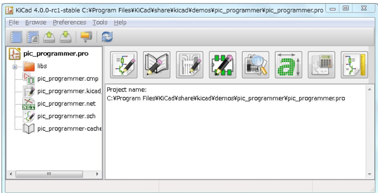
La ventana principal KiCad se compone de una vista tipo árbol del proyecto, un panel que contiene botones que sirven para ejecutar las distintas herramientas del software, y una ventana de mensaje. El menú y la barra de herramientas se pueden utilizar para crear, leer y guardar archivos de proyecto.
